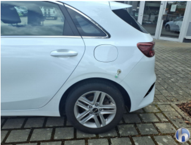
2. Seitenwand - Hinten - Links Rost - Smart Repair
