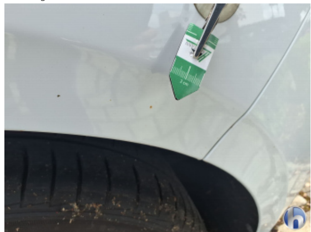
2. Seitenwand - Hinten - Links Rost - Smart Repair
