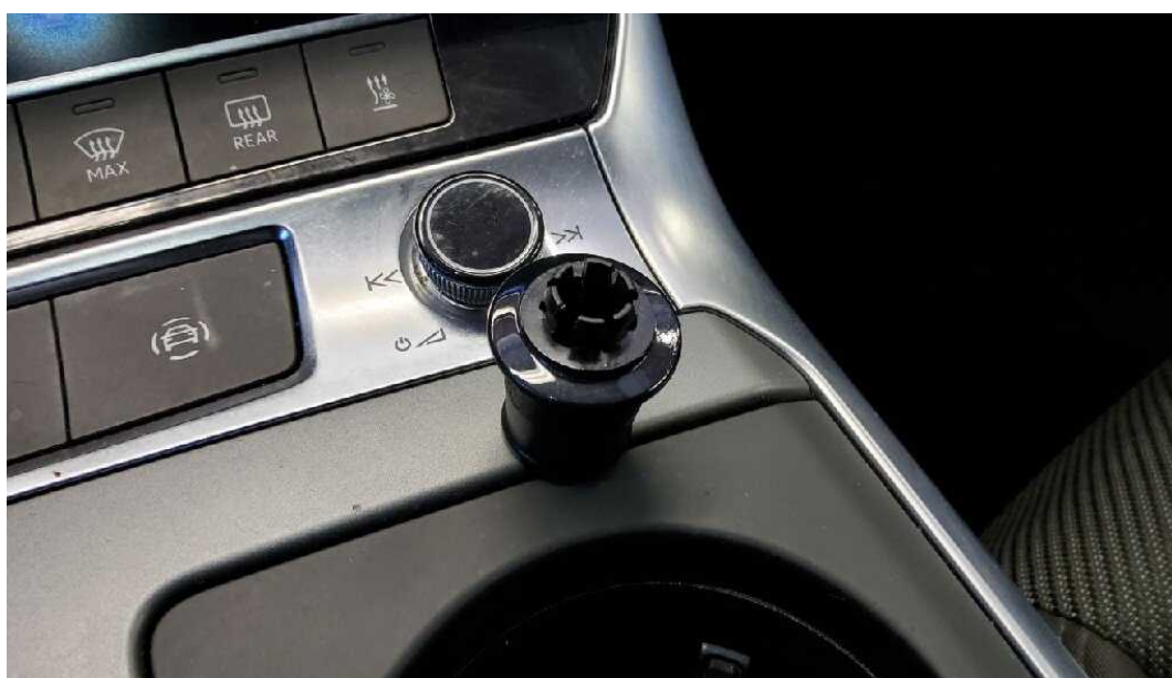
Bild 20 Fahrzeug Blindstopfen 12V Steckdose beschädigt
