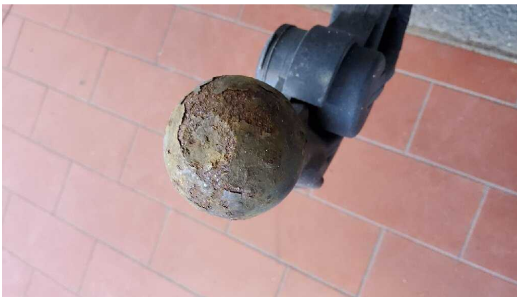
Bild 21 Fahrzeugzubehör Anhängerkupplung Korrosion - Reibwert Anhängerstabilisierung
