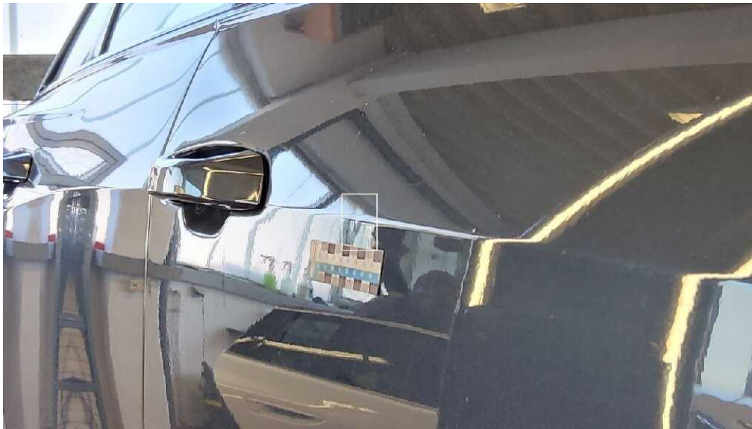
Bild 33 rechte Seite Tür vorne rechts Leichte Delle
