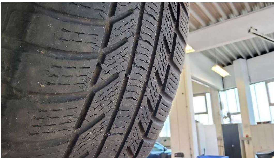
Bild 31 Winterreifen V.A. (keine Ausstattung) verschlissen
