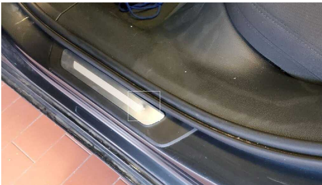
Bild 26 Innenraum Einstieg hinten links Blende verdellt
