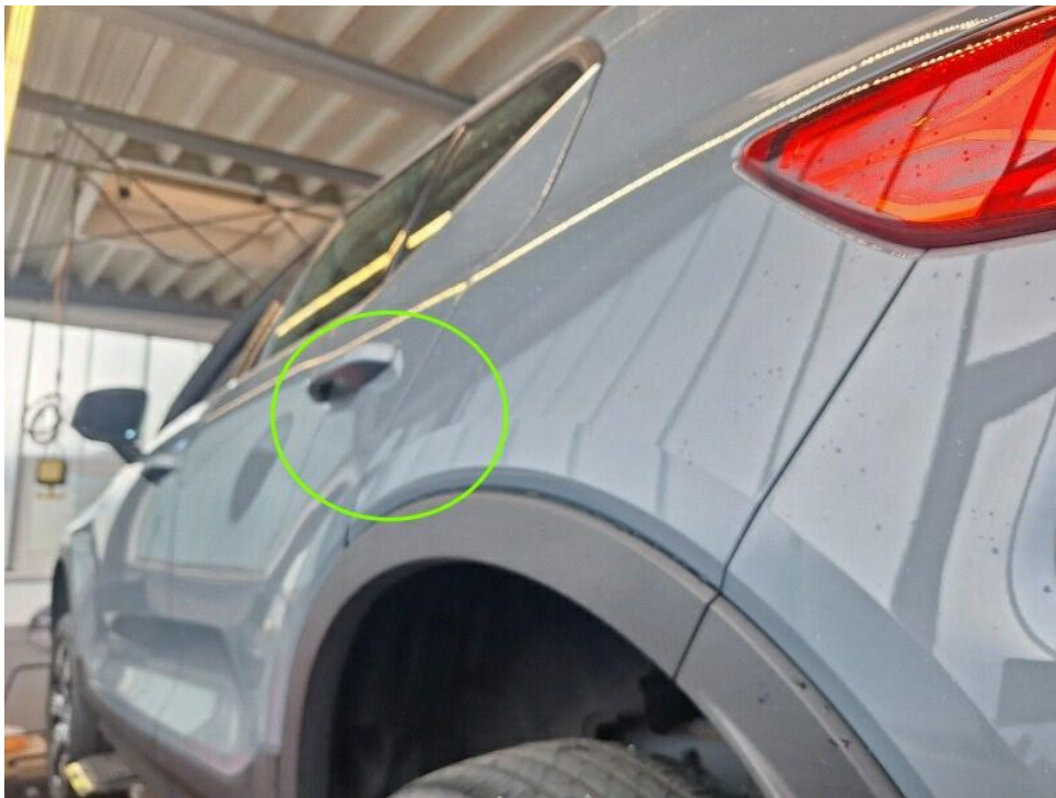
Bild 14 : Seitenteil hinten links eingedellt
