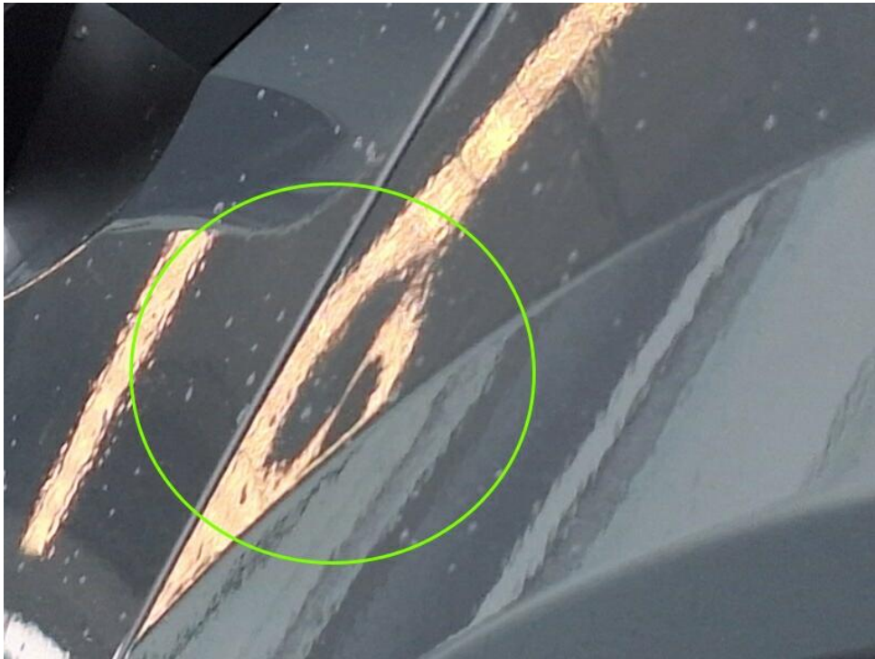
Bild 15 : Seitenteil hinten links eingedellt
