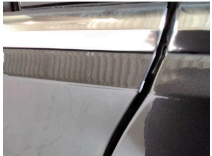
Damage 4: Door - front left side: Door edge - Scratch(es) - Smart repair
