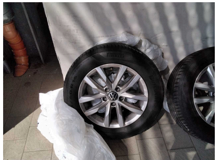
Damage 8: 2nd wheel set: 1 tyre (Fremdkörper im Reifen) - Damaged - Replace
