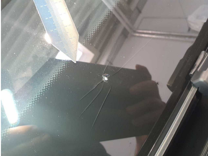
Damage 2: Vehicle glazing: Windscreen (kein Staubschutz) - Stone chips - Replace
