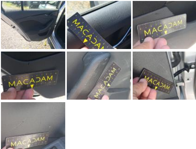
Door panel RR, Scratch(es), Replace
