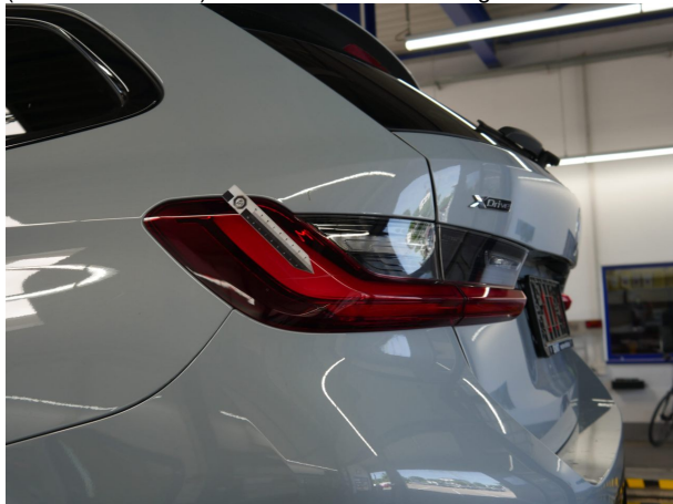
Beschädigung #6: Heckleuchte: Heckleuchte links - Kratzer - erneuern
