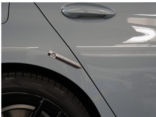
Beschädigung #2: Seitenwand rechts: Seitenwand - Kratzer - Smart Repair
