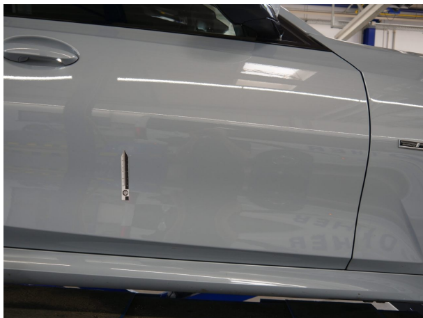
Beschädigung #1: Tür vorn rechts: Tür - Kratzer - auslegen / polieren
