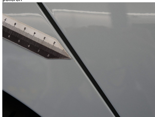
Beschädigung #2: Seitenwand rechts: Seitenwand - Kratzer - Smart Repair
