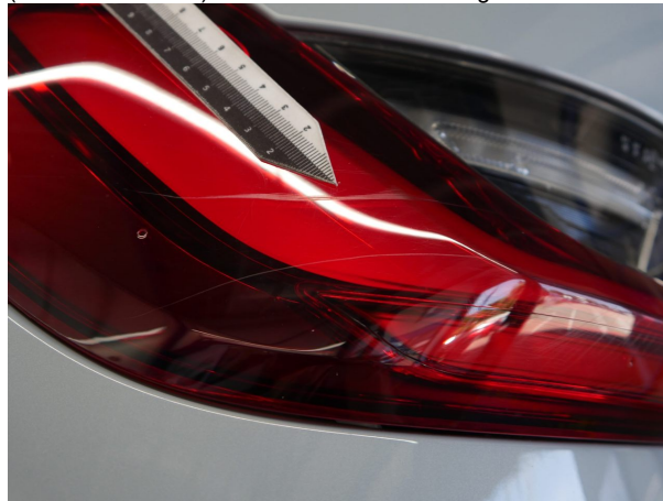
Beschädigung #6: Heckleuchte: Heckleuchte links - Kratzer - erneuern
