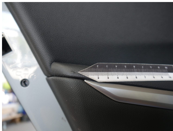
Beschädigung #4: Verkleidungen/Abdeckungen: Türverkleidung hinten links - Kratzer - Smart Repair
