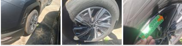
Alloy rim FL bitone/polychrome, Scratch(es), Repair/replace (lump sum)
