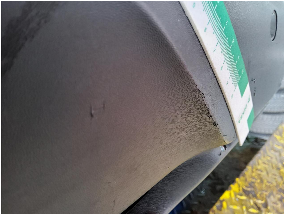
Bild 13 : Stoßfänger hinten Unterteil zerkratzt, im Verbund erneuern
