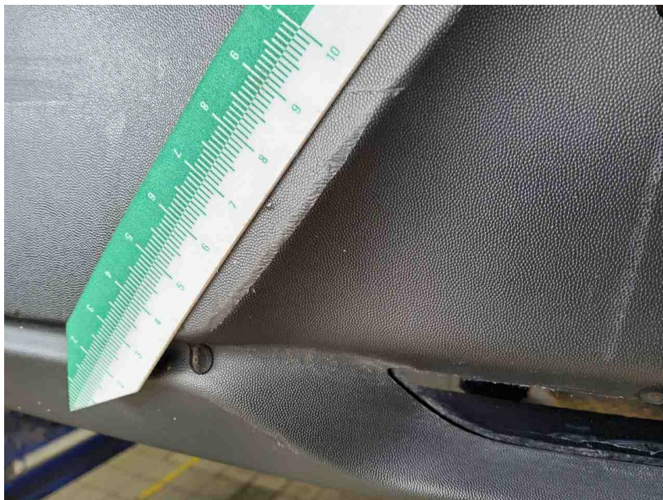
Bild 12 : Stoßfänger hinten Unterteil zerkratzt, im Verbund erneuern
