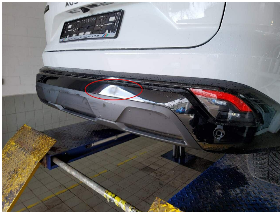
Bild 10 : Stoßfänger hinten zerkratzt
