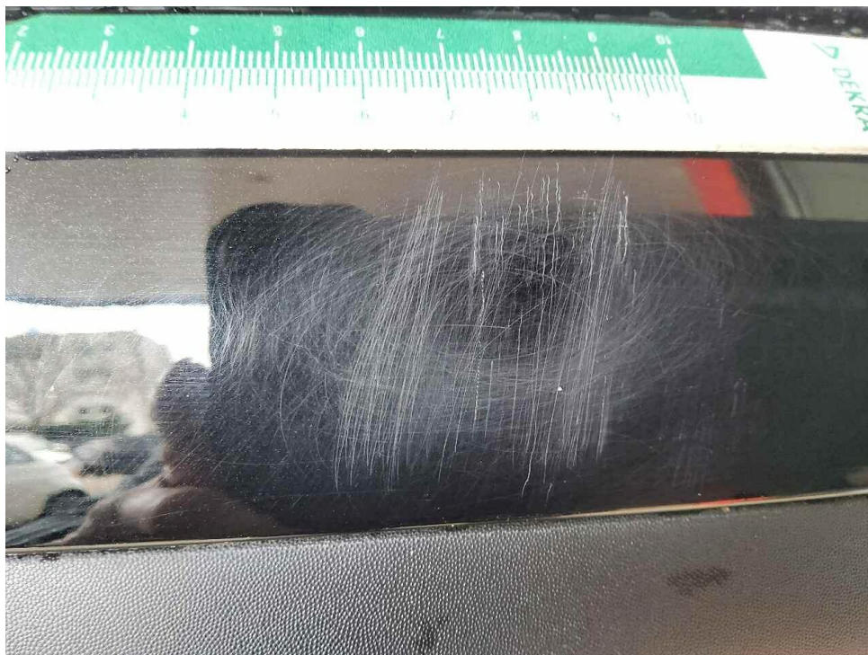
Bild 11 : Stoßfänger hinten zerkratzt
