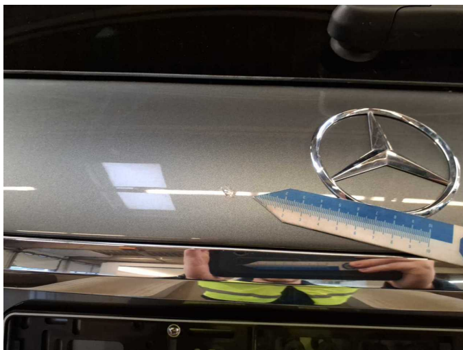
Damage 6: Boot lid / rear door: Boot lid (Harzflecken-Mehrkosten möglich) - Paint defect - Conditioning
