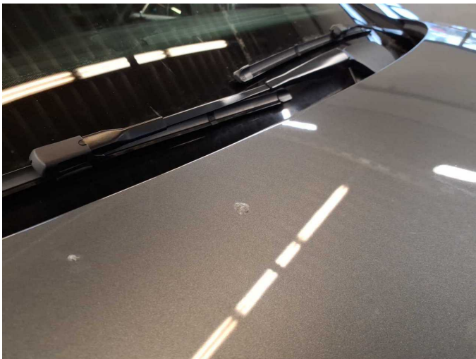
Damage 4: Bonnet: Bonnet (Harzflecken-Mehrkosten möglich) - Paint defect - Conditioning
