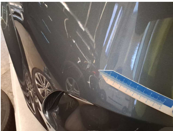
Damage 3: Rear bumper: Rear bumper (Harzflecken-Mehrkosten möglich) - Paint defect - Conditioning
