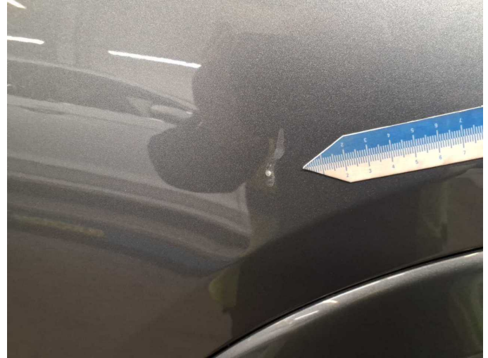
Damage 2: Mudguard - right side: Mudguard - right side (Harzflecken-Mehrkosten möglich) - Paint defect - Conditioning
