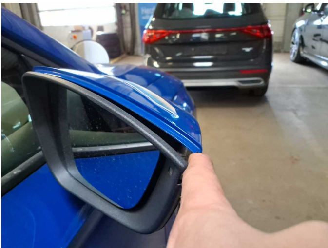
Damage 3: Wing mirror - right side: Cap (Vermutlich Halterungen gebrochen) - Loose - Replace
