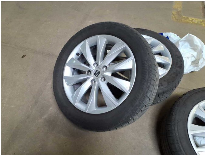
Damage 2: 2nd wheel set: 2 tyres (Einseitig abgefahren) - Worn - Replace
