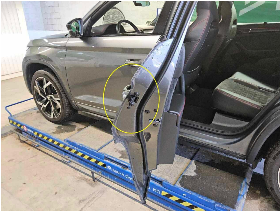
Bild 27 : Türe hinten links, Kantenschutz gebrochenen
