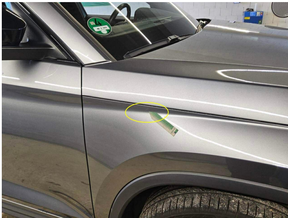
Bild 18 : Kotflügel vorne rechts Lackierung, zerkratzt, smart repair
