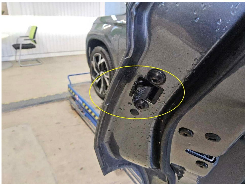
Bild 26 : Türe hinten links, Kantenschutz gebrochenen
