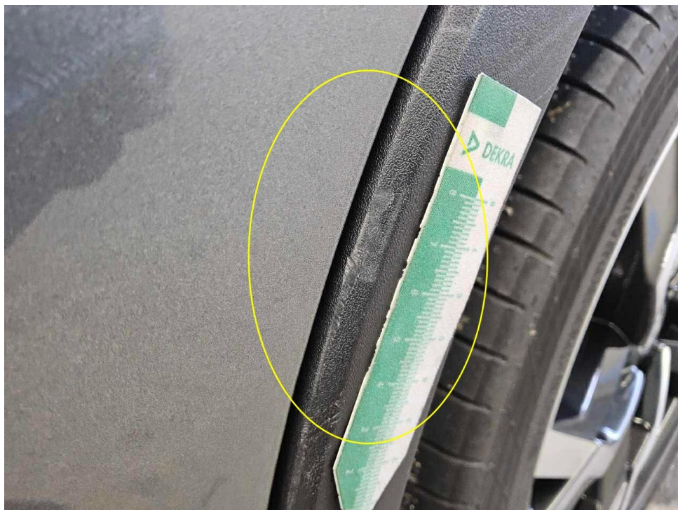
Bild 30 : Radlaufblende hinten links zerkratzt
