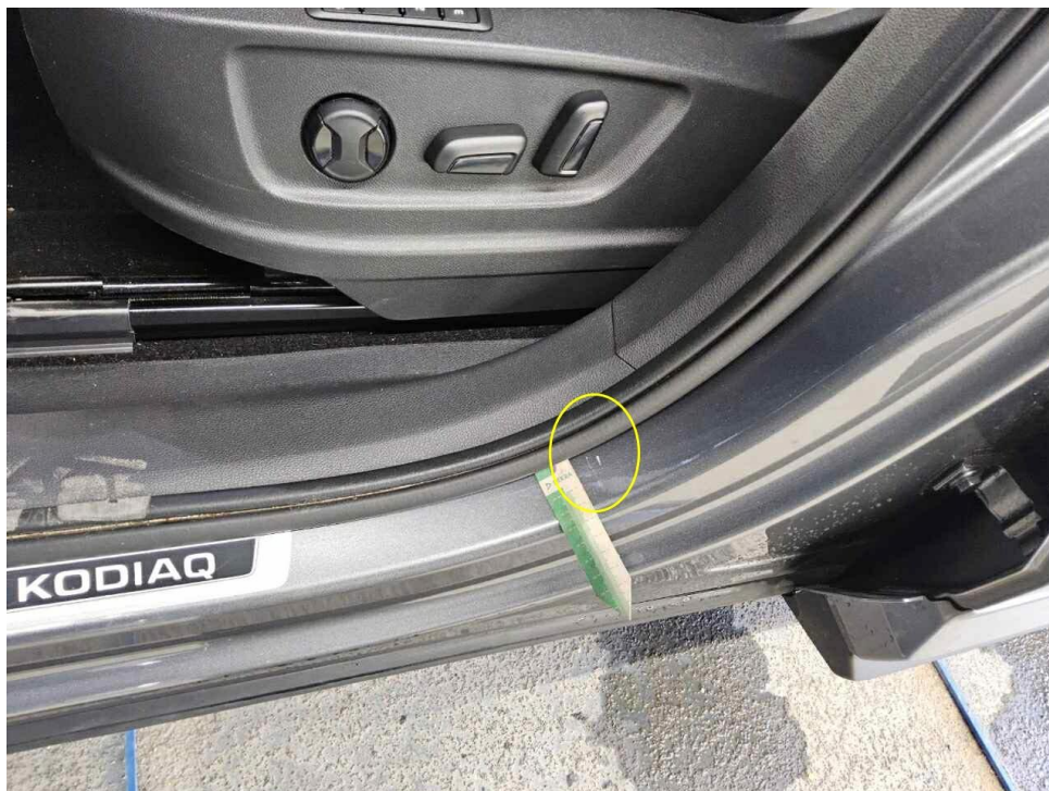
Bild 24 : Tür vorne links Einstieg, zerkratzt, smart repair
