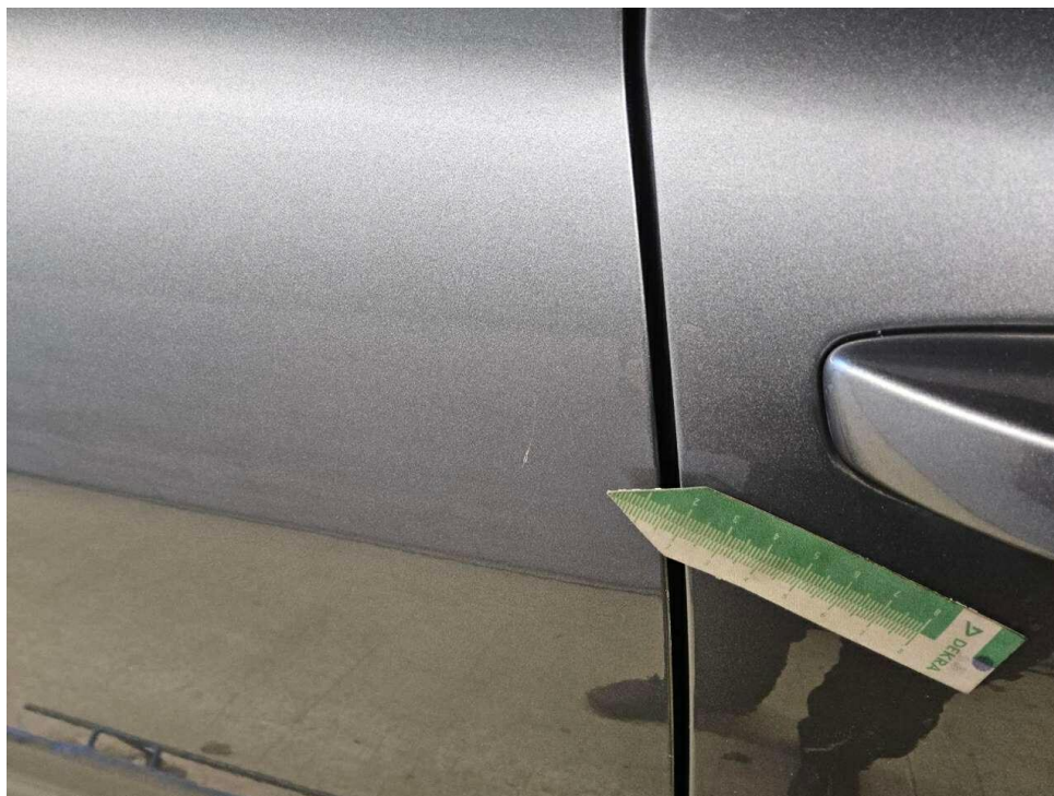
Bild 23 : Tür hinten rechts Lackierung, zerkratzt, Gebrauchsspur
