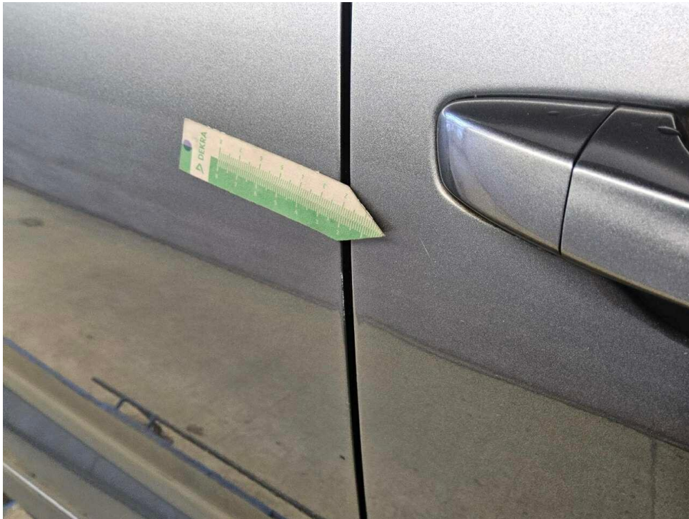
Bild 21 : Tür vorne rechts Lackierung, zerkratzt, Gebrauchsspur
