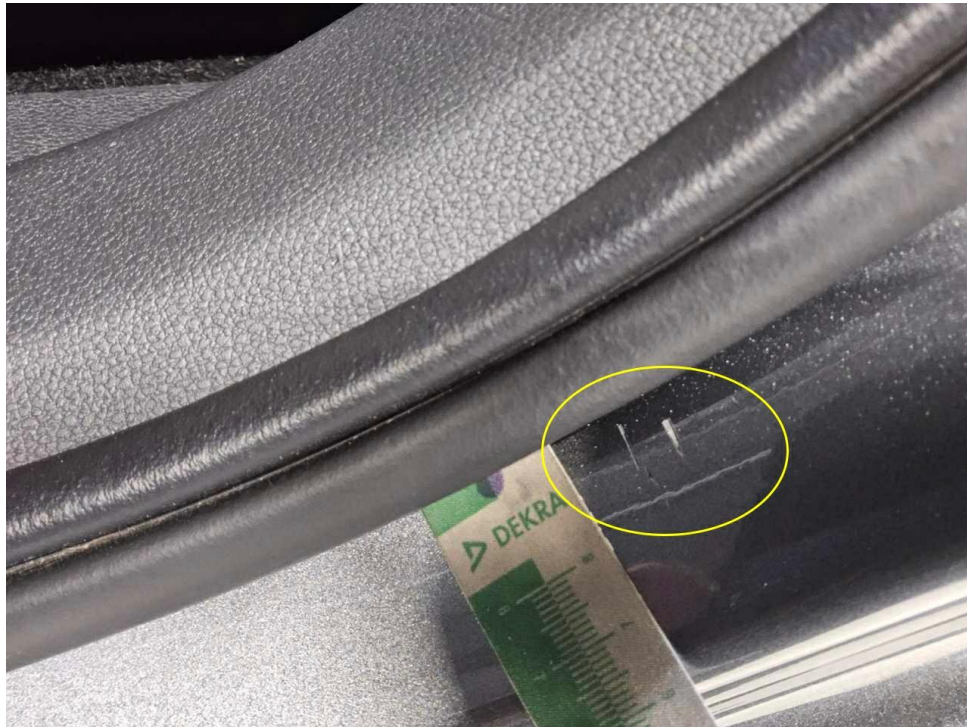
Bild 25 : Tür vorne links Einstieg, zerkratzt, smart repair
