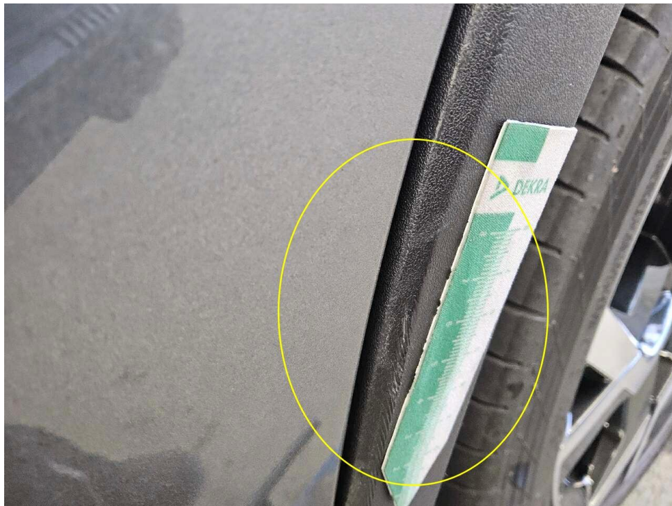
Bild 31 : Radlaufblende hinten links zerkratzt
