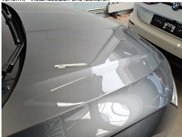
Beschädigung #4: Motorhaube: Motorhaube - Delle(n) - instandsetzen und lackieren
