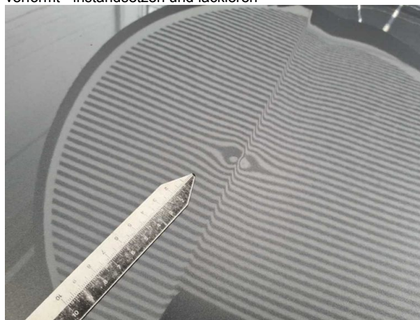
Beschädigung #4: Motorhaube: Motorhaube - Delle(n) - instandsetzen und lackieren
