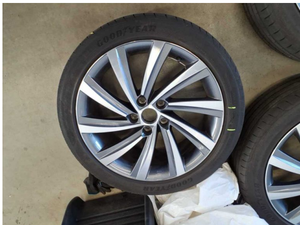
Beschädigung #1: 2.Radsatz: 1 Reifen - gebrochen / gerissen - erneuern
