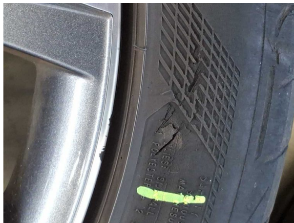
Beschädigung #1: 2.Radsatz: 1 Reifen - gebrochen / gerissen - erneuern
