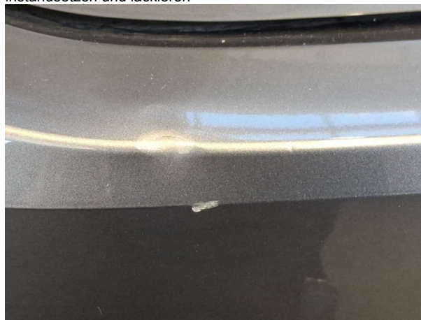
Beschädigung #3: Stossfänger hinten: Stossfänger hinten - verformt - instandsetzen und lackieren
