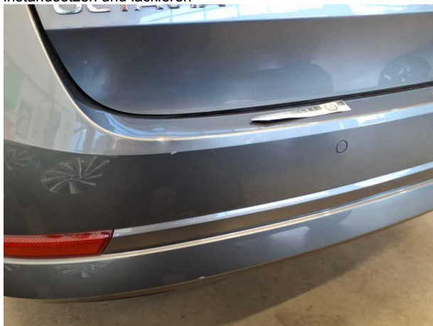
Beschädigung #3: Stossfänger hinten: Stossfänger hinten - verformt - instandsetzen und lackieren
