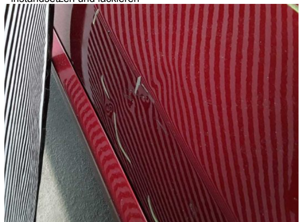
Beschädigung #20: Tür vorn rechts: Tür - Delle / Lackschaden - instandsetzen und lackieren
