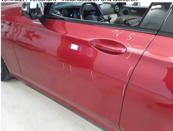
Beschädigung #19: Tür vorn links: Tür - verkratzt / verschürft - instandsetzen und lackieren
