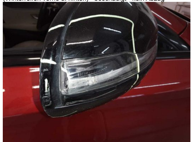
Beschädigung #6: Blinkleuchte: Spiegel rechts - verkratzt / verschürft - erneuern
