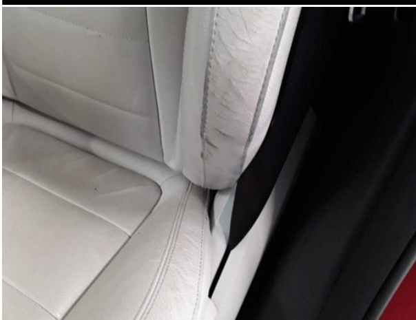
Beschädigung #15: Sitz vorn: Sitzbezug links - porös / rissig - erneuern
