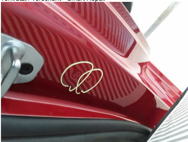
Beschädigung #12: Seitenwand links: Einstieg - Delle(n) - sanft instandsetzen
