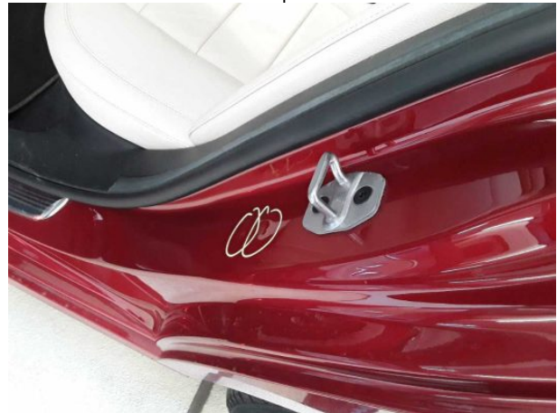
Beschädigung #12: Seitenwand links: Einstieg - Delle(n) - sanft instandsetzen
