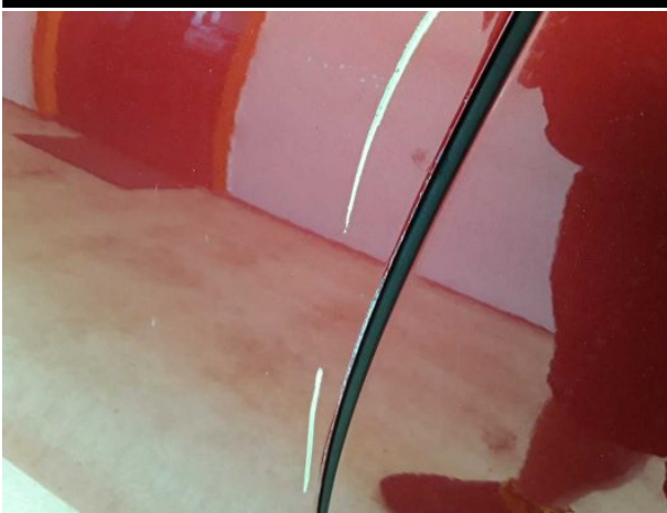
Beschädigung #19: Tür vorn links: Tür - verkratzt / verschürft - instandsetzen und lackieren
