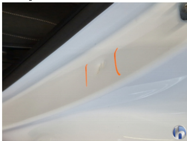
2. Türeinstieg Hinten - Links Beschädigt - Sanft Instandsetzen
