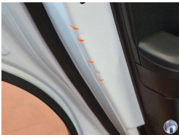
1. Tür Hinten - Links Beschädigt - Sanft Instandsetzen
