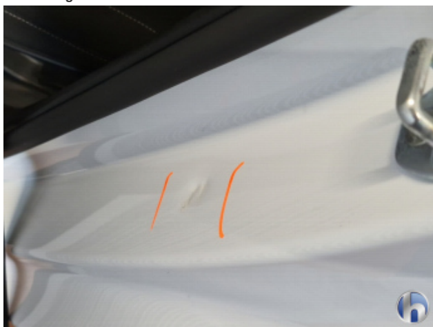
2. Türeinstieg Hinten - Links Beschädigt - Sanft Instandsetzen
