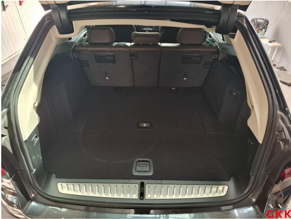
Bild 13. Laderaum, Abdeckung, fehlt, ersetzen
