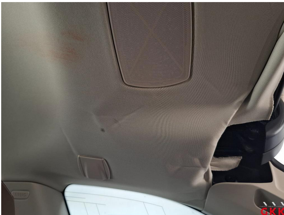
Bild 15. Himmel, beschädigt, ersetzen
