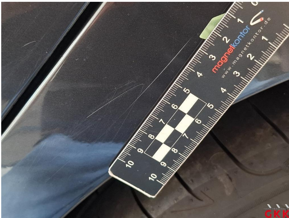
Bild 28. Seitenwand links, beschädigt, lackieren
