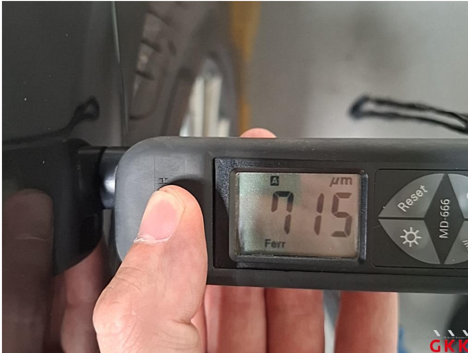
Bild 35. Seitenwand links, Reparaturmangel, instand setzen - lackieren
