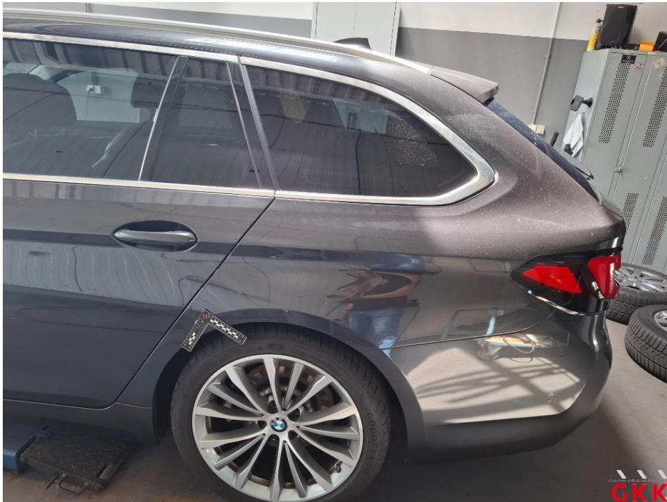
Bild 26. Seitenwand links, beschädigt, lackieren
