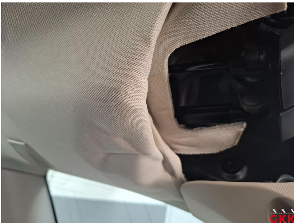
Bild 16. Himmel, beschädigt, ersetzen
