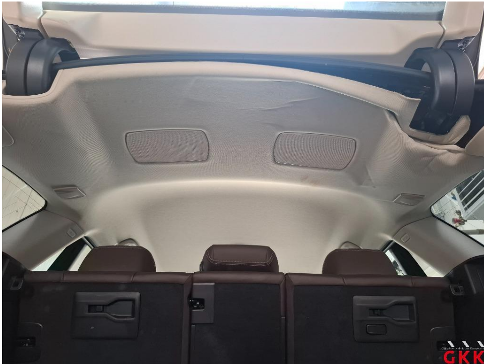
Bild 14. Himmel, beschädigt, ersetzen
