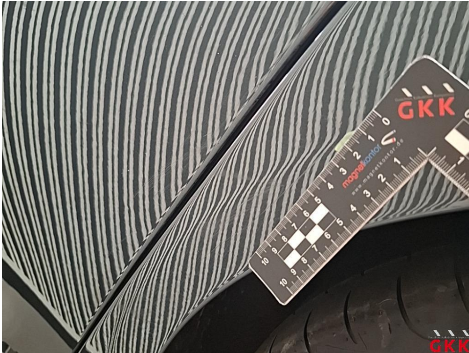
Bild 27. Seitenwand links, beschädigt, lackieren
