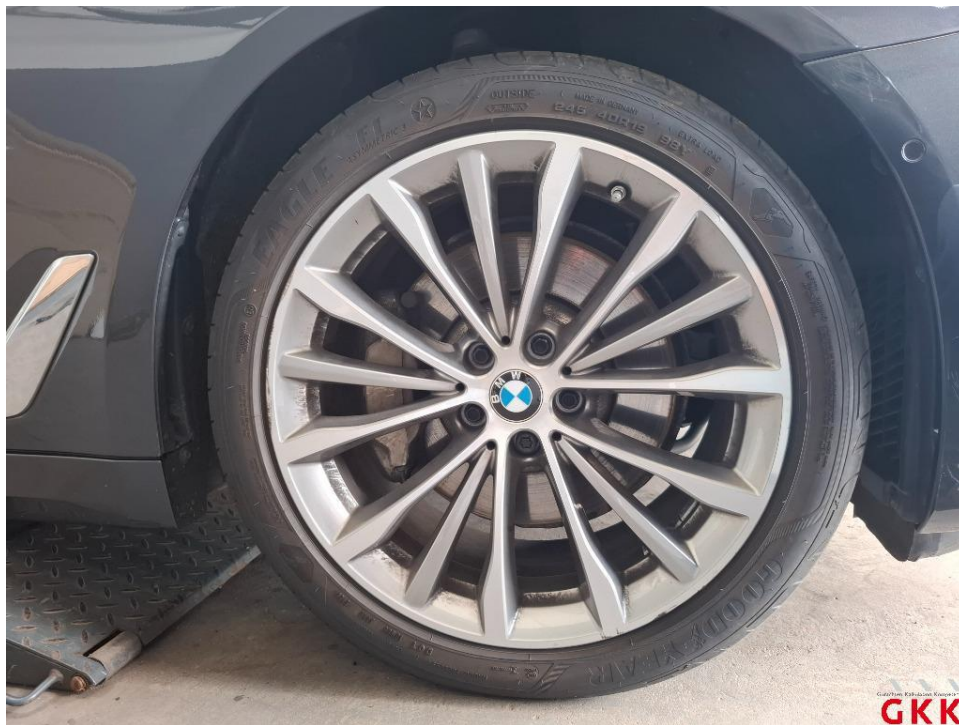
Bild 32. LM-Rad, vorne rechts, beschädigt, ersetzen
