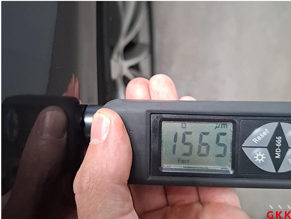
Bild 38. Seitenwand rechts, Reparaturmangel, lackieren
