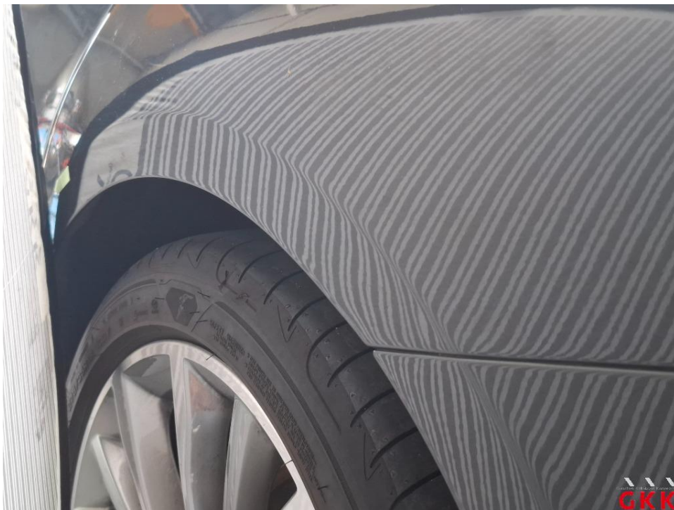
Bild 36. Seitenwand links, Reparaturmangel, instand setzen - lackieren
