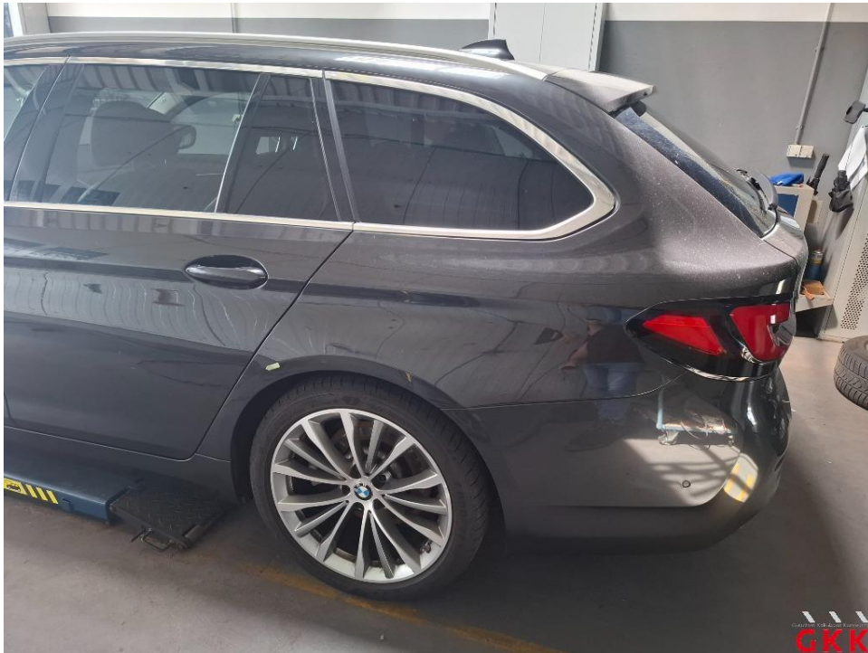
Bild 34. Seitenwand links, Reparaturmangel, instand setzen - lackieren
