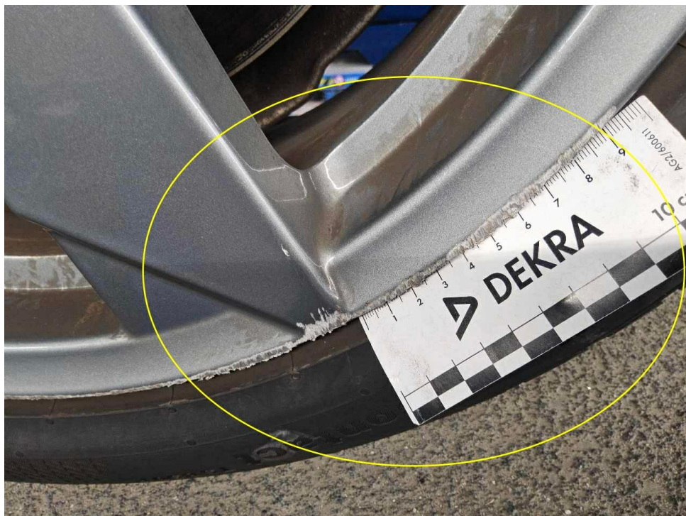
Bild 30 : LM Felge vorne links verschrammt, Winter
