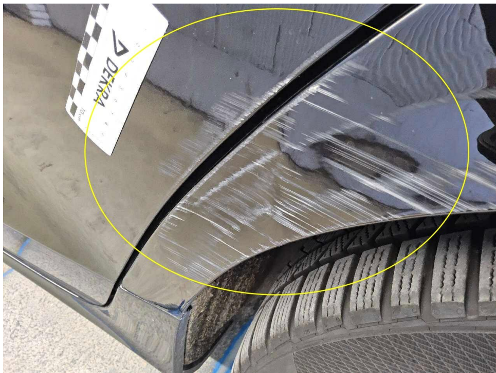
Bild 24 : Schaden Seite hinten links
