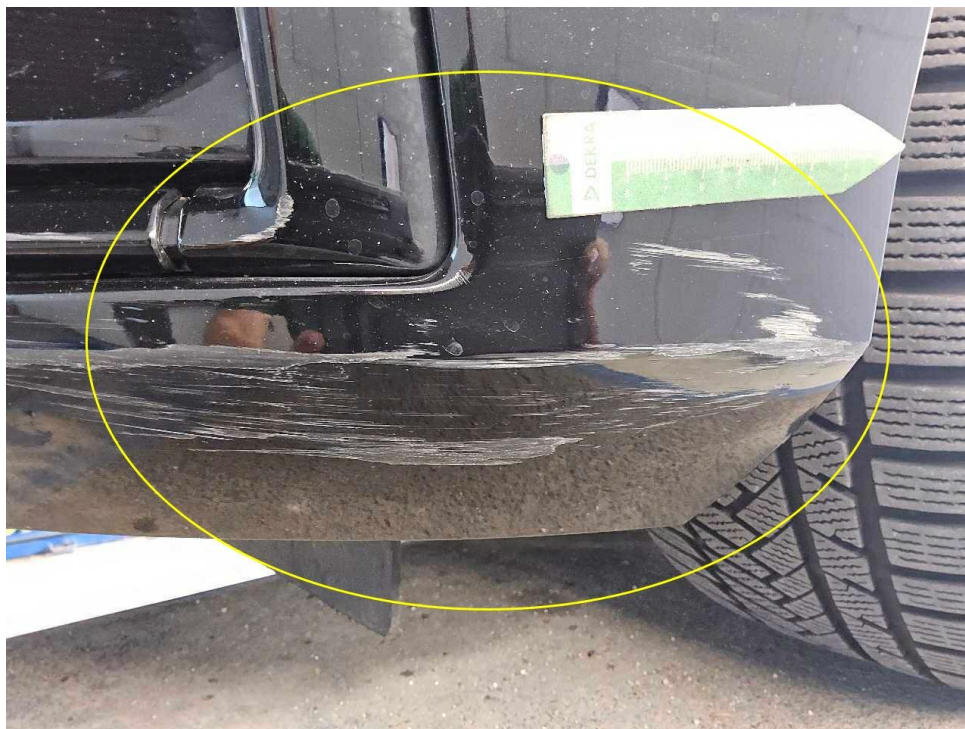
Bild 27 : Schaden Stoßfänger vorne
