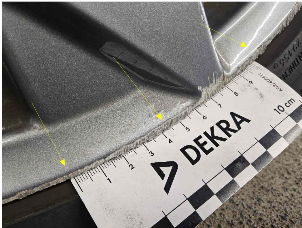
Bild 29 : LM Felge vorne links verschrammt, Winter
