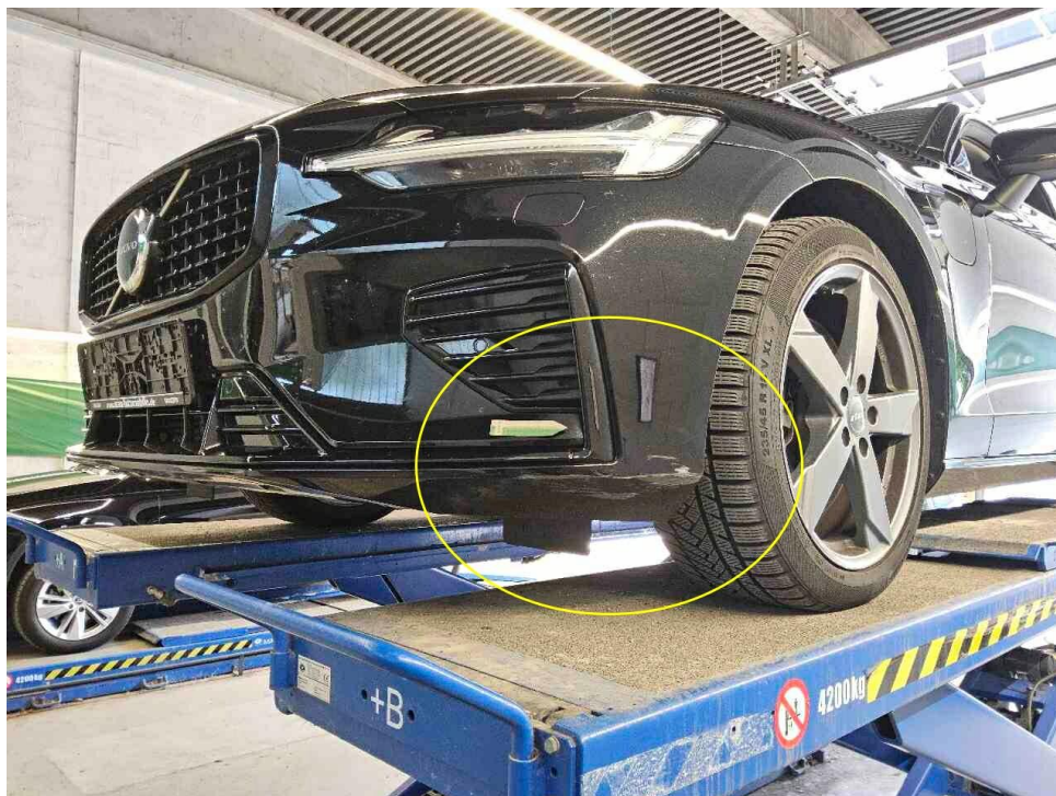
Bild 26 : Schaden Stoßfänger vorne
