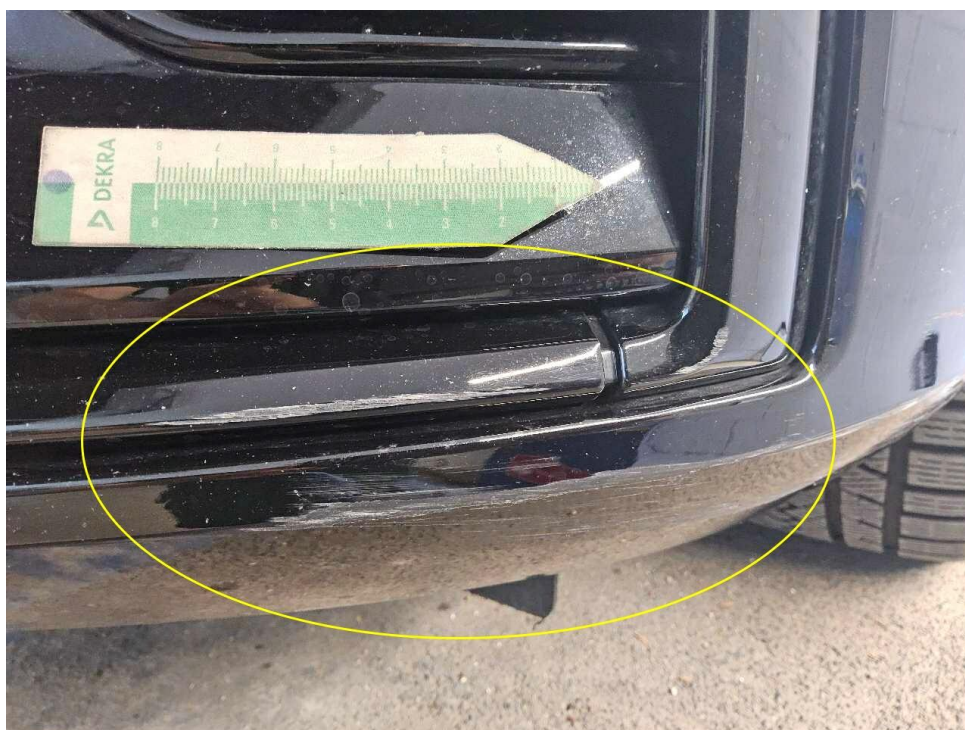
Bild 28 : Schaden Stoßfänger vorne
