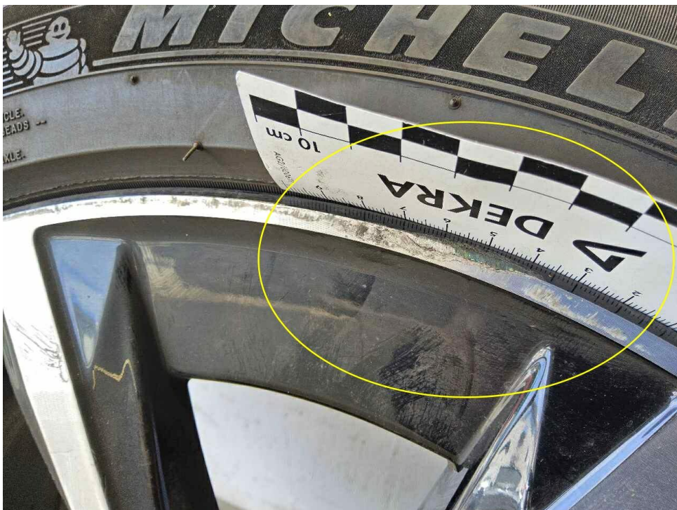
Bild 36 : LM Felge vorne rechts glanzgedreht verschrammt, Sommer
