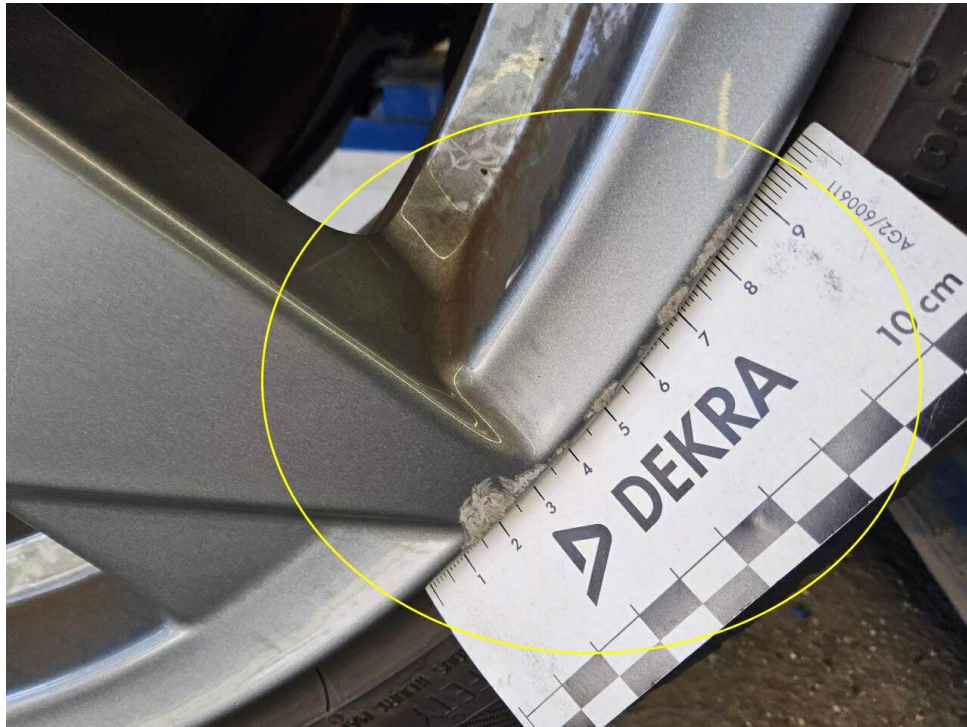
Bild 33 : LM Felge hinten rechts verschrammt, Winter
