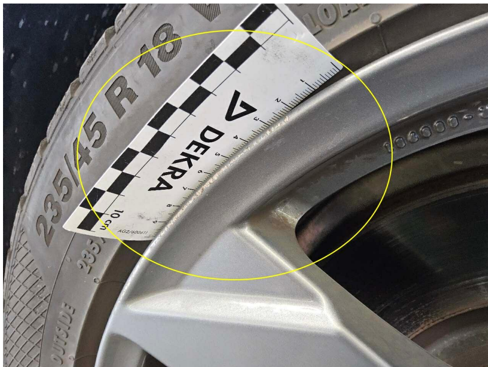
Bild 34 : LM Felge vorne rechts verschrammt, Winter
