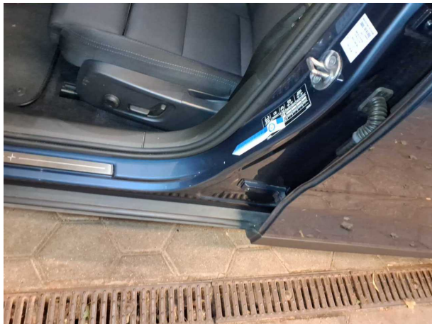
Beschädigung #1: Schweller links: Einstieg - Lackmangel - Smart Repair
