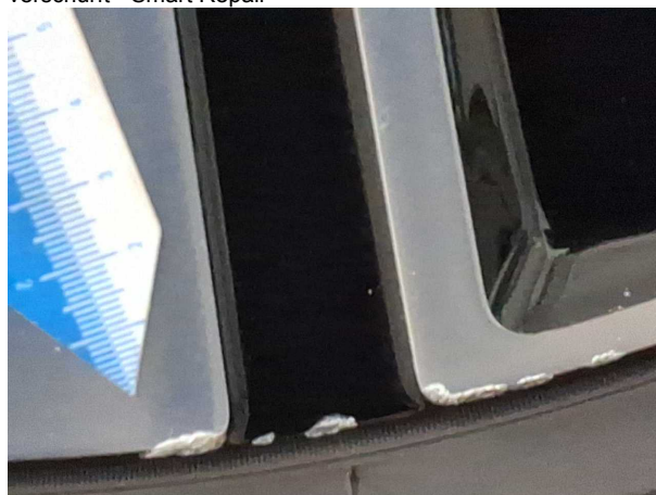
Beschädigung #3: Rad/Reifen: Leichtmetallfelge hinten rechts (Sommer) - verkratzt / verschürft - Wertminderung
