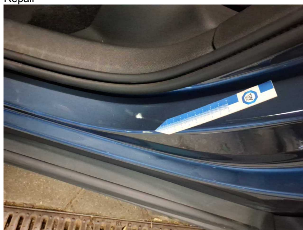
Beschädigung #2: Seitenwand links: Einstieg - verkratzt / verschürft - Smart Repair
