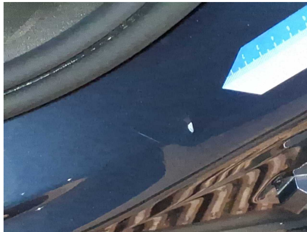
Beschädigung #1: Schweller links: Einstieg - Lackmangel - Smart Repair
