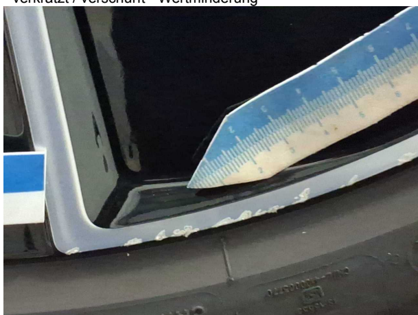
Beschädigung #4: Rad/Reifen: Leichtmetallfelge vorn rechts (Sommer... - verkratzt / verschürft - Wertminderung
