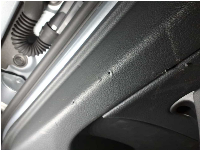
Beschädigung #26: Verkleidungen/Abdeckungen: Türverkleidung hinten rechts - gebrochen / gerissen - erneuern
