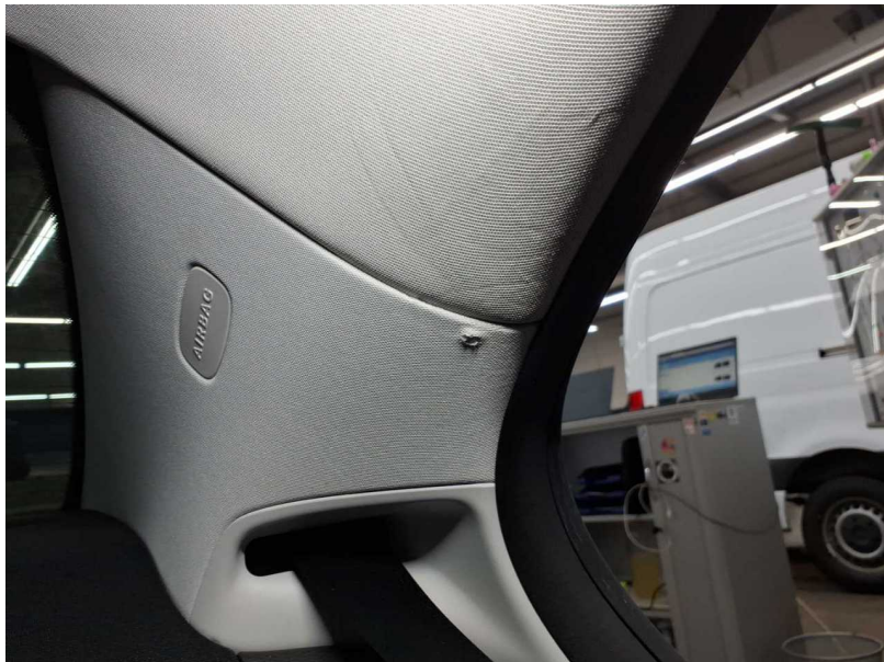
Beschädigung #11: Verkleidungen/Abdeckungen: C-Säule links Verkleidung innen - gebrochen / gerissen - erneuern
