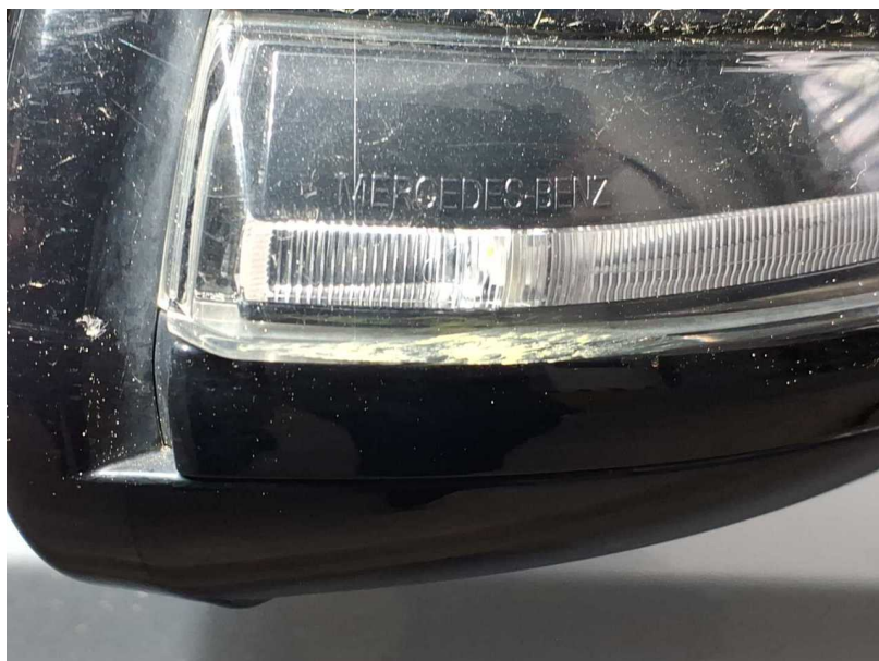
Beschädigung #7: Blinkleuchte: Spiegel rechts - verkratzt / verschürft - erneuern
