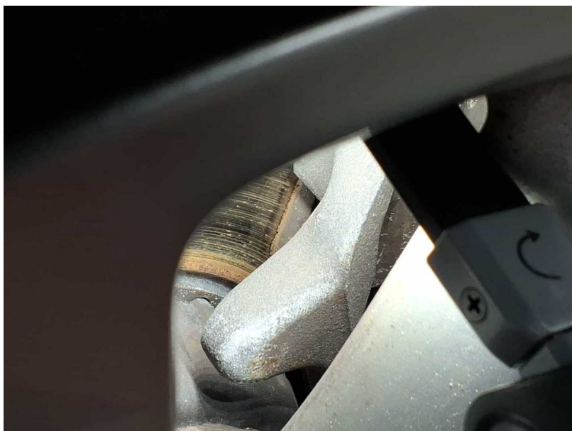
Beschädigung #13: Bremsanlage: Bremsbeläge vorn - verschlissen - erneuern
