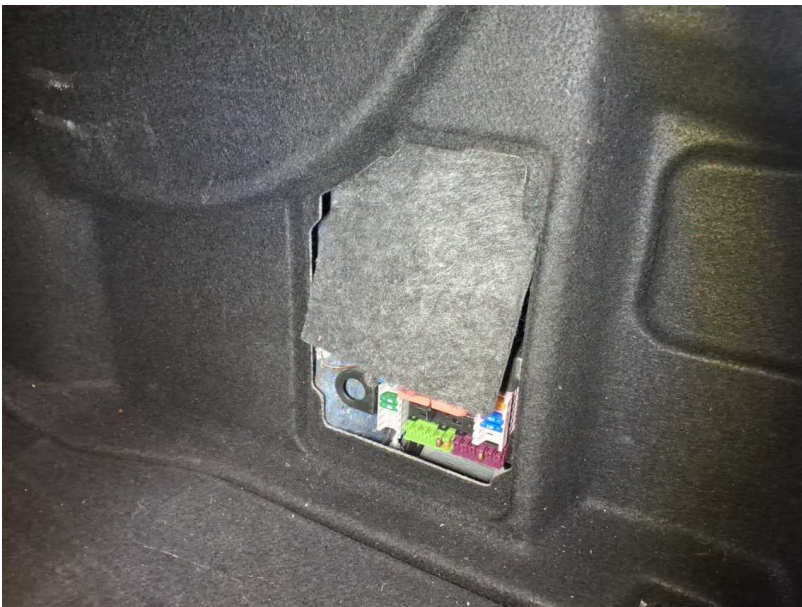
Beschädigung #1: Verkleidungen/Abdeckungen: Verkleidungen/Abdeckungen - fehlt - erneuern
