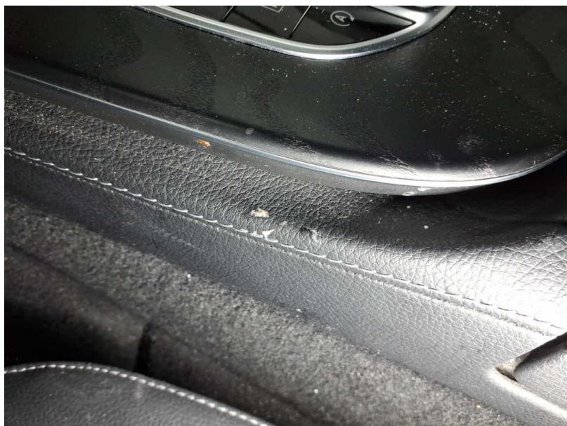
Beschädigung #6: Instrumententafel: Mittelkonsole vorn - gebrochen / gerissen - Smart Repair
