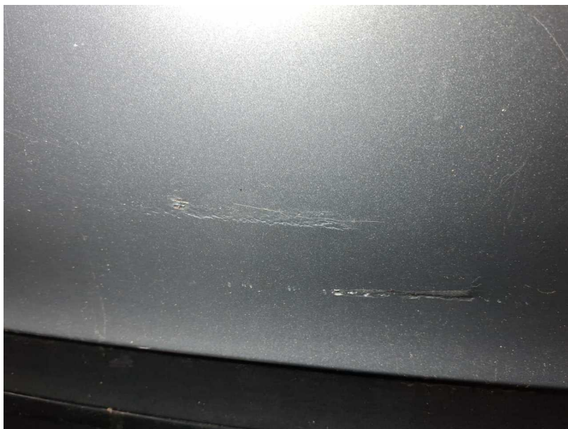
Beschädigung #27: Stossfänger hinten: Stossfänger hinten (Kostenausweitung möglich) - verformt - erneuern
