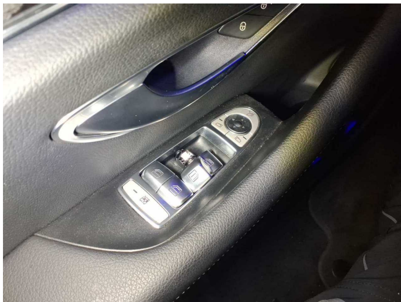
Beschädigung #9: Tür vorn links: Schaltereinheit - gebrochen / gerissen - erneuern
