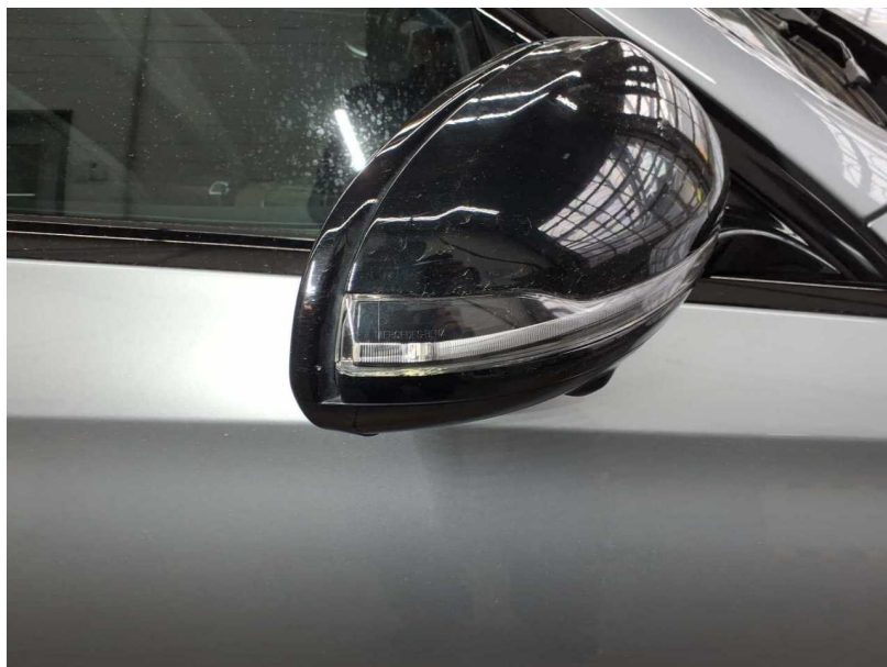
Beschädigung #7: Blinkleuchte: Spiegel rechts - verkratzt / verschürft - erneuern
