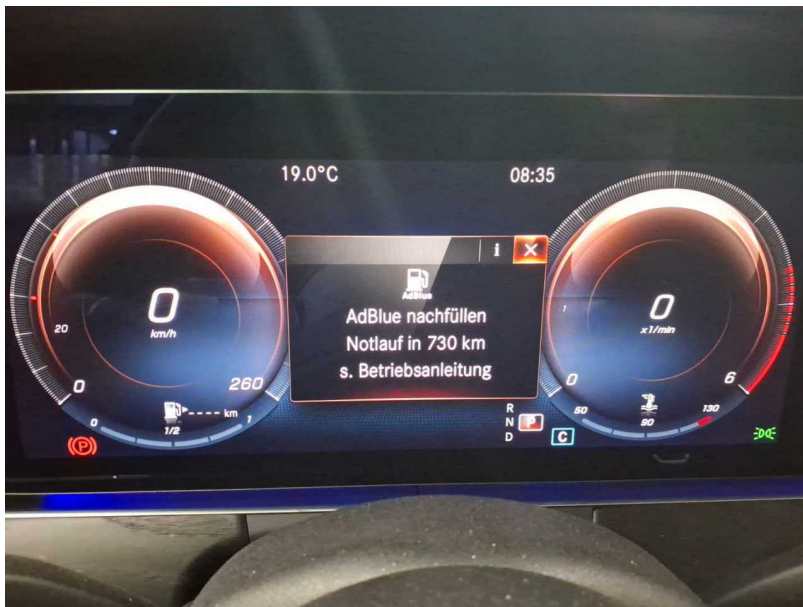
Beschädigung #4: Abgasanlage: AdBlue Tank - leer - instandsetzen
