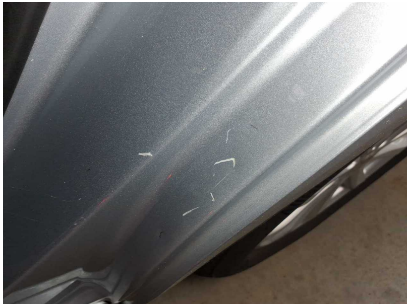
Beschädigung #16: Seitenwand links: Einstieg - Delle(n) - instandsetzen und lackieren
