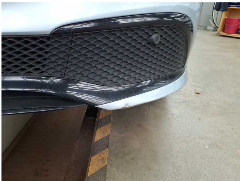
Beschädigung #28: Stossfänger vorn: Stossfänger vorn (+ Grill unten und 4x Zierleiste, Kostenausweitung möglich) - verformt - erneuern
