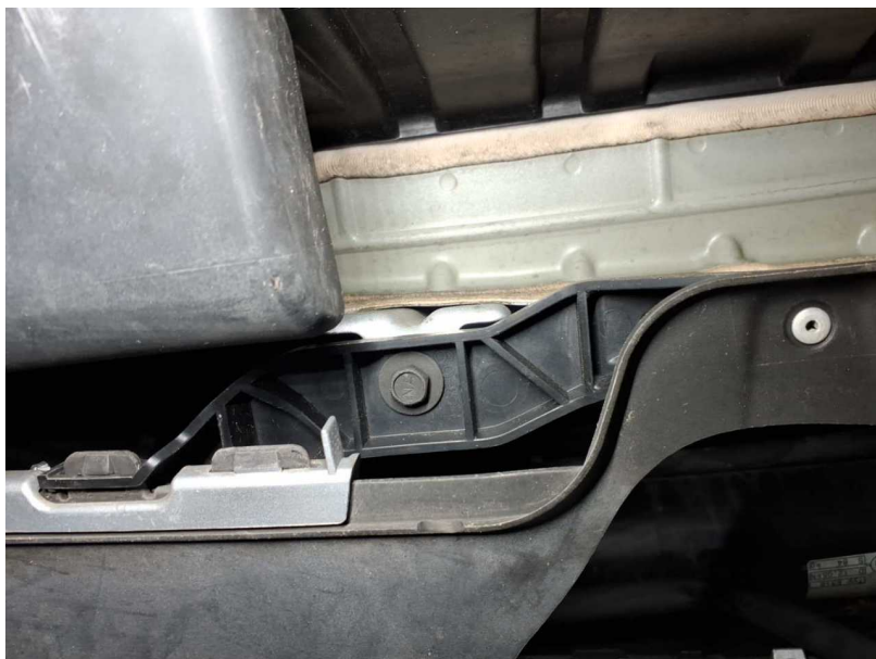
Beschädigung #15: Heckbereich: Heckblech - verformt - instandsetzen und lackieren
