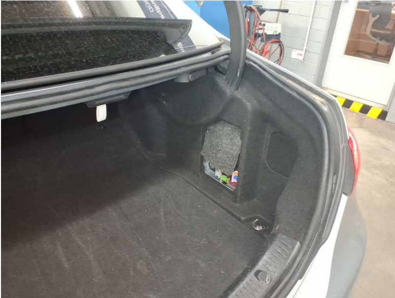
Beschädigung #1: Verkleidungen/Abdeckungen: Verkleidungen/Abdeckungen - fehlt - erneuern
