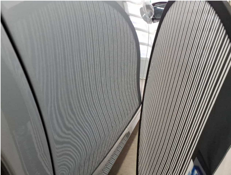
Beschädigung #22: Tür hinten rechts: Tür (Wellig und Einschlüsse im Lack) - nicht fachgerecht instandgesetzt - instandsetzen und lackieren
