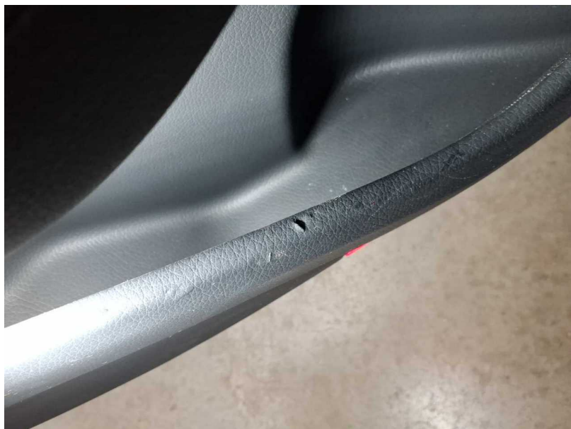
Beschädigung #25: Verkleidungen/Abdeckungen: Türverkleidung hinten links - gebrochen / gerissen - erneuern
