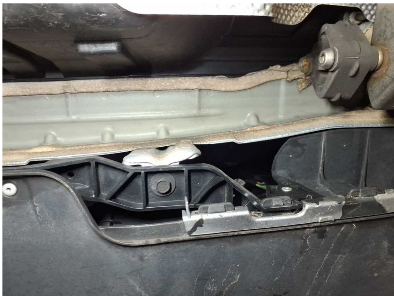
Beschädigung #15: Heckbereich: Heckblech - verformt - instandsetzen und lackieren
