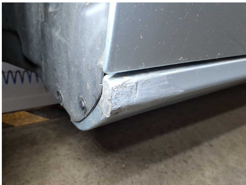
Beschädigung #19: Schweller links: Verkleidung (Kostenausweitung möglich) - nicht fachgerecht instandgesetzt - erneuern
