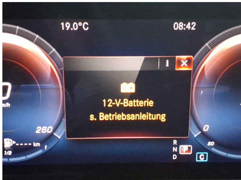
Beschädigung #14: elektrisches System: Batterie (Kostenausweitung möglich) - elektrischer Fehler - erneuern
