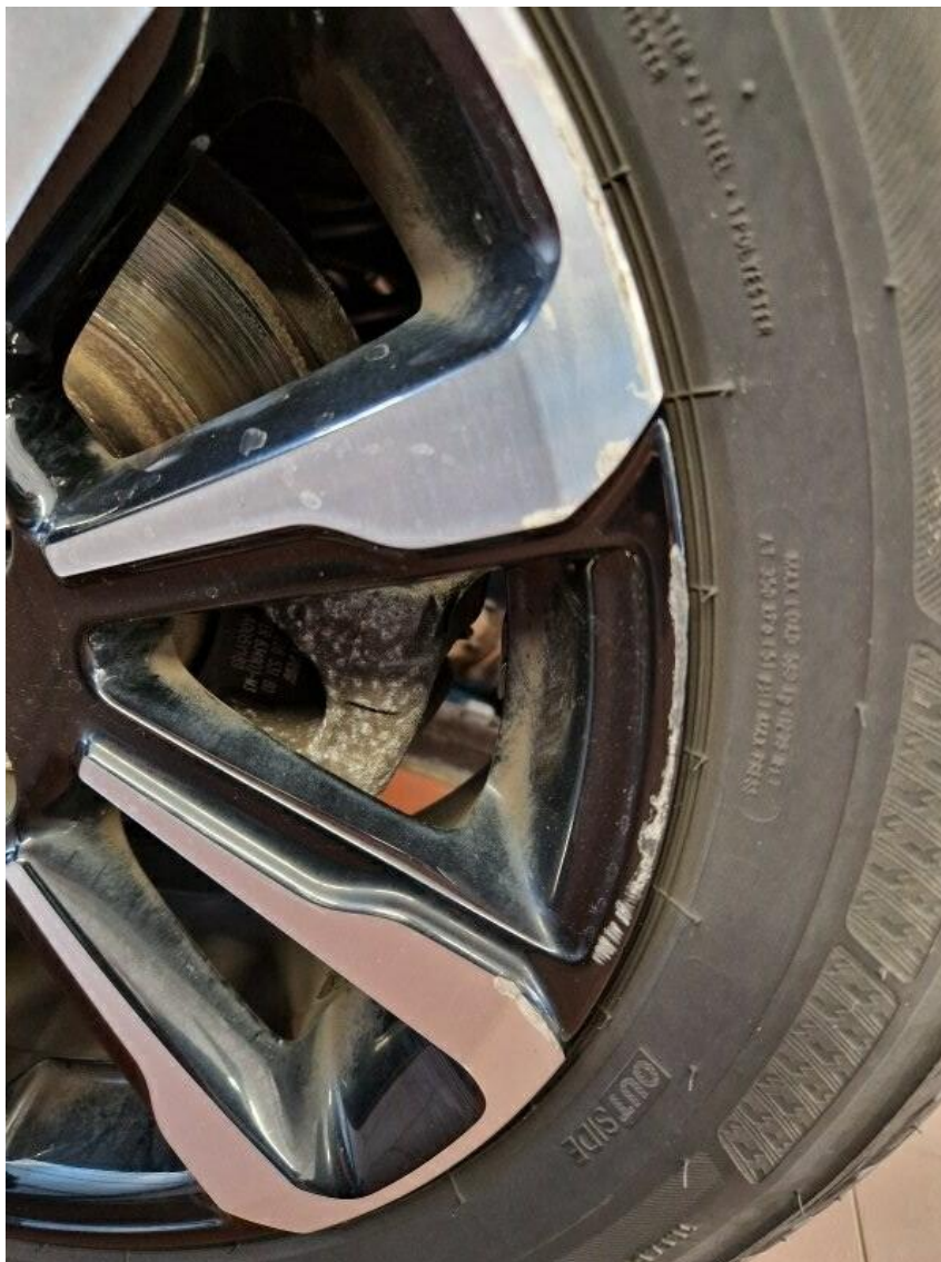
Bild 15 : Leichtmetallfelge hinten links verschrammt, erneuern
