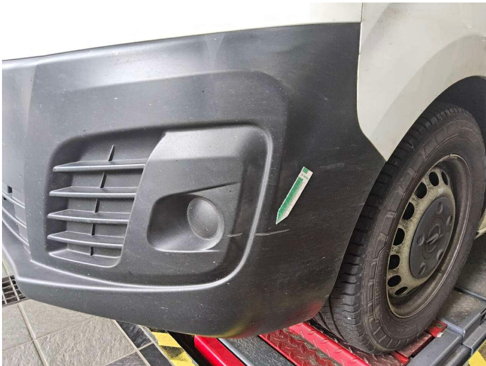
Bild 14 : Stoßfänger vorn links, verschrammt
