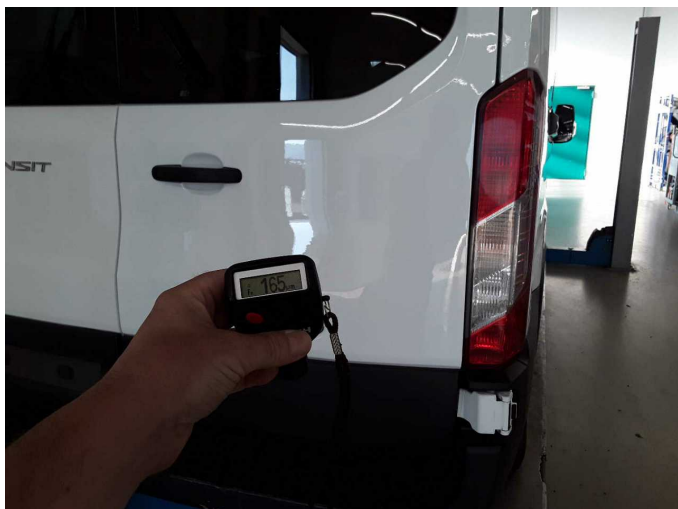
Boot lid / rear door: 165 µm
