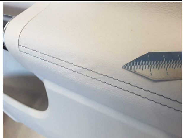
Beschädigung #5: Verkleidungen/Abdeckungen: Türverkleidung hinten rechts - verformt - erneuern
