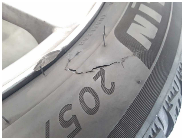
Beschädigung #2: 2.Radsatz: 1 Reifen - gebrochen / gerissen - kein Abzug
