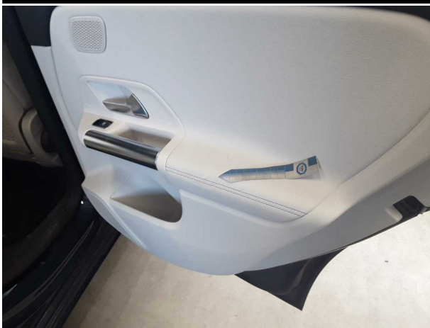
Beschädigung #5: Verkleidungen/Abdeckungen: Türverkleidung hinten rechts - verformt - erneuern
