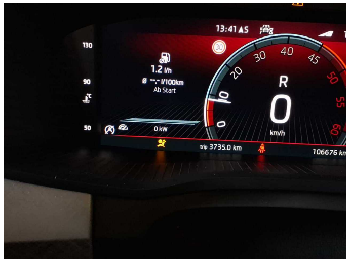
Damage 7: Airbag systems: Airbag system (Folgekosten möglich) - on - Perform diagnosis
