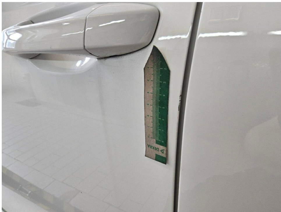
Bild 16 : Tür vorne links Türkante, Lackabplatzer, Gebrauchsspur
