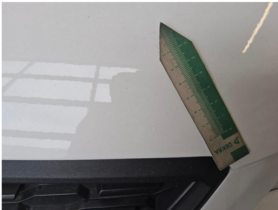
Bild 19 : Motorhaube Lackierung, Steinschlag, Gebrauchsspur
