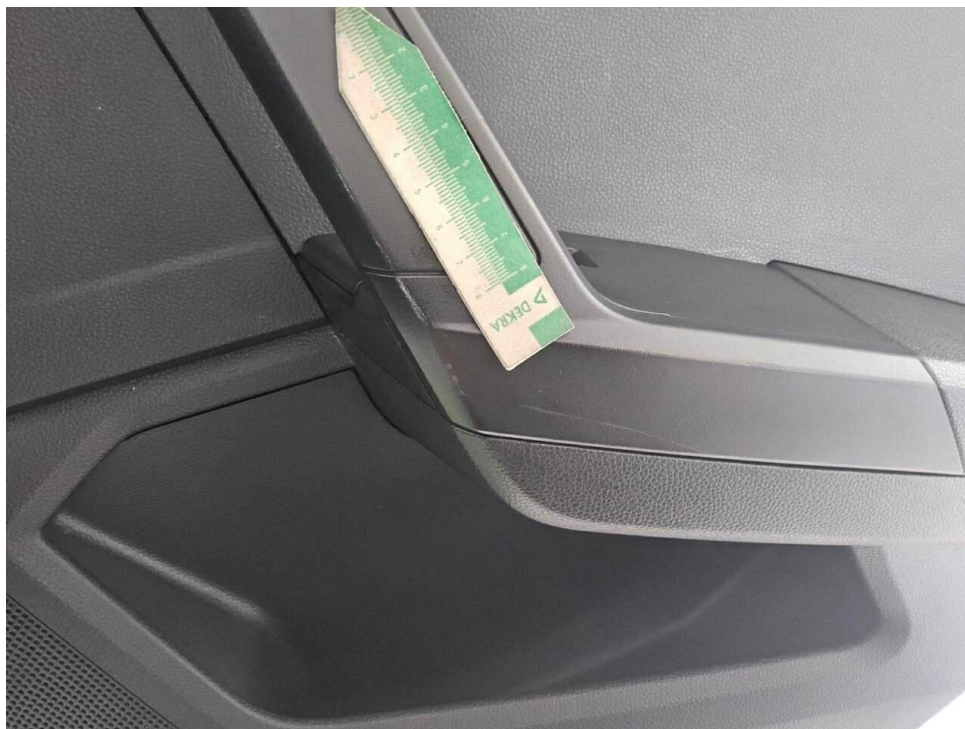
Bild 15 : Verkleidung Tür hinten Griff rechts, verschrammt, Gebrauchsspur
