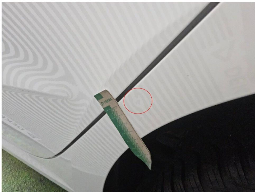
Bild 22 : Seitenteil hinten links, eingedellt, drücken
