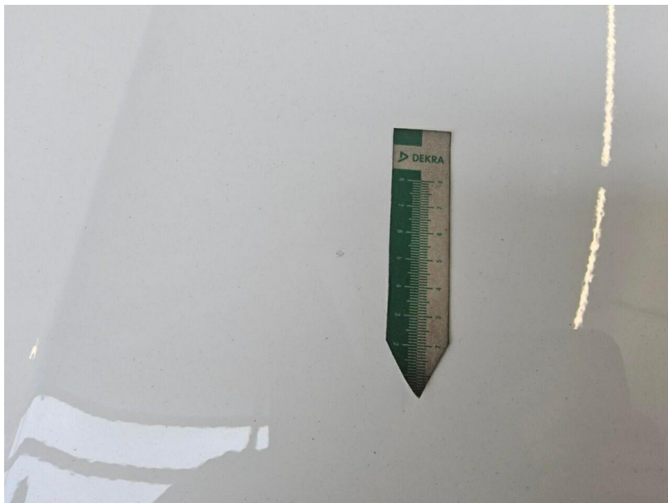
Bild 20 : Motorhaube Lackierung, Steinschlag, Gebrauchsspur
