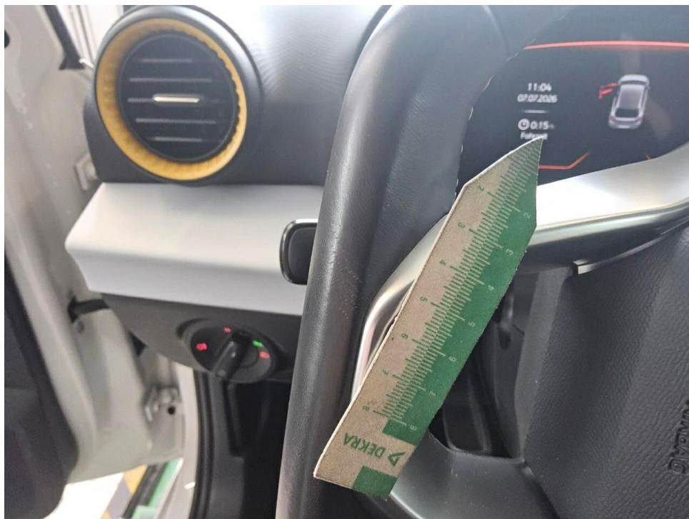
Bild 18 : Lenkrad, verschrammt, Gebrauchsspur
