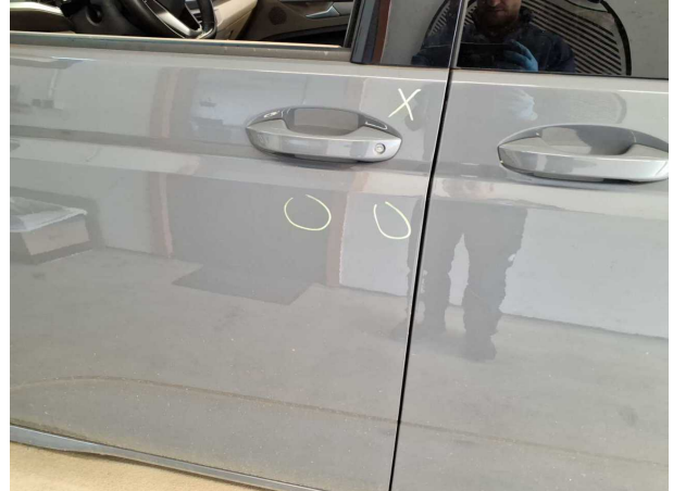
Beschädigung #3: Tür vorn links: Tür - Delle(n) - sanft instandsetzen
