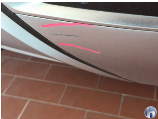
4. Stoßfänger Hinten Abschürfung - Lackieren
