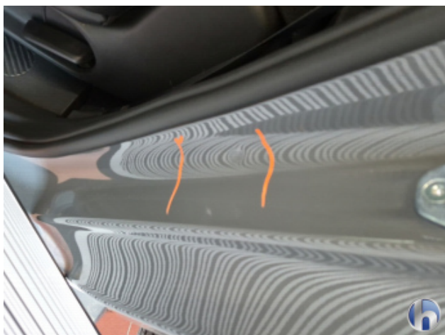
3. Türeinstieg Hinten - Links 1 Delle - Sanft Instandsetzen
