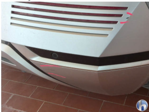
4. Stoßfänger Hinten Abschürfung - Lackieren
