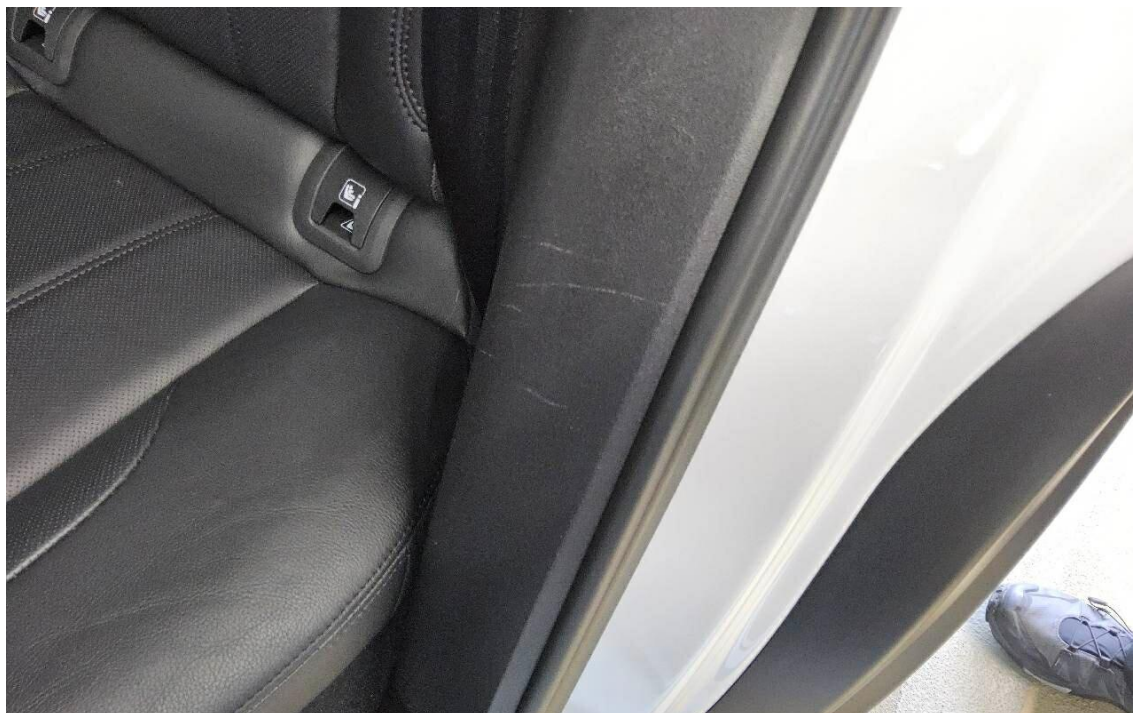
Bild 15 : Einstieg hinten links, Verkleidung verschrammt
