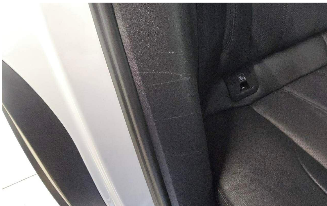
Bild 16 : Einstieg hinten rechts, Verkleidung verschrammt
