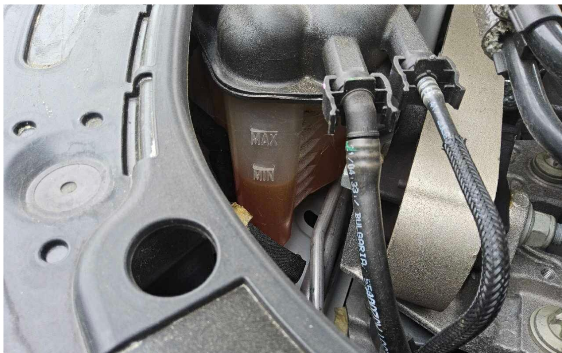
Bild 14 : Kühlwasserstand zu gering
