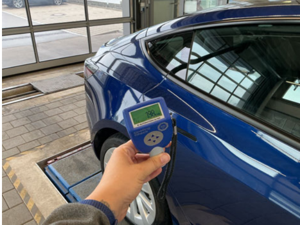
Nachlackierung 1: Dachholm rechts, Seitenwand rechts
