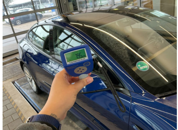
Nachlackierung 1: Dachholm rechts, Seitenwand rechts
