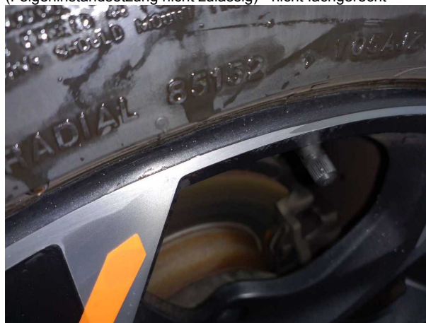
Beschädigung #4: Rad/Reifen: Leichtmetallfelge hinten rechts (Felgeninstandsetzung nicht zulässig) - nicht fachgerecht
