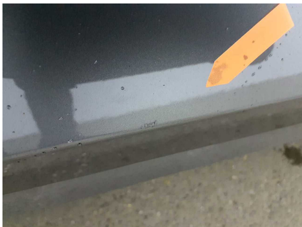
Beschädigung #3: Tür vorn rechts: Tür (Blende) - verkratzt / verschürft - Smart Repair
