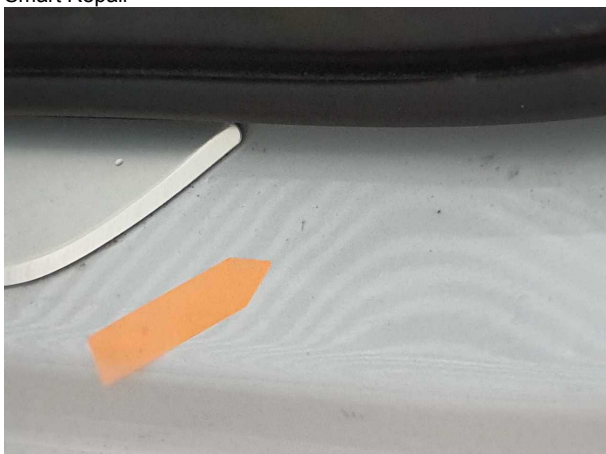
Beschädigung #2: Schweller links: Einstieg - Delle / Lackschaden - Smart Repair
