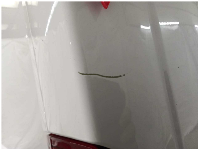
Damage 1: Body: D-pillar - right side (Lackierung bereits im Unfallschaden enthalten) - Scratch(es)
