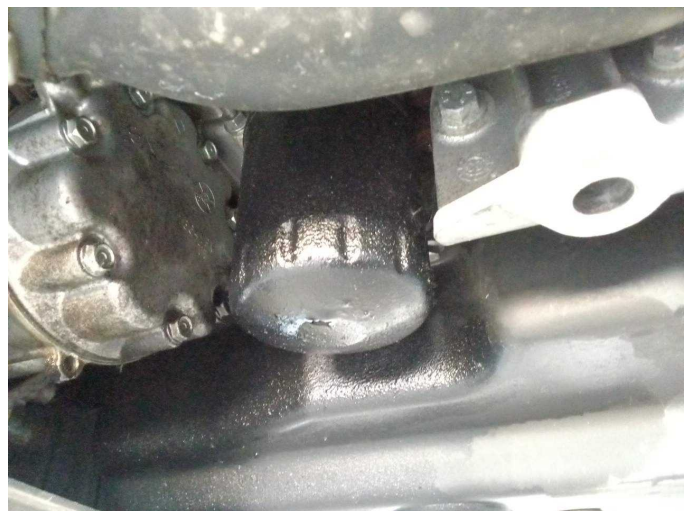
Damage 6: Engine: Engine (Ölverlust - Folgekosten möglich) - Leaking - Perform diagnosis
