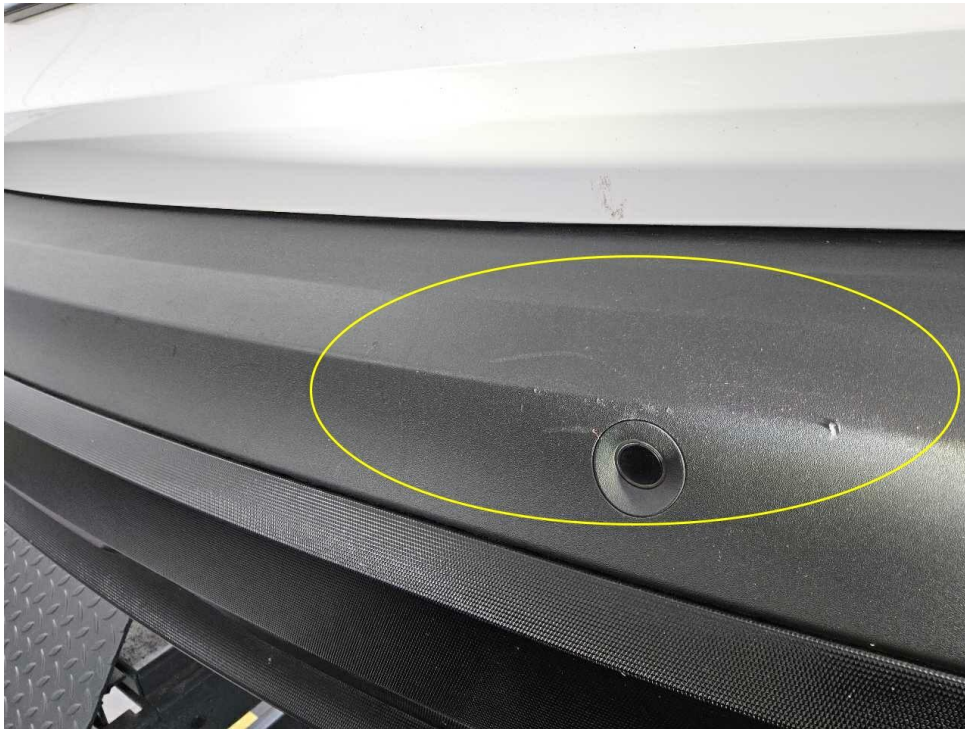
Bild 17 : Stoßfänger hinten mehrfach zerschrammt
