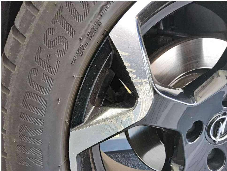
Bild 15 : Felge vorne rechts mehrfach zerschrammt
