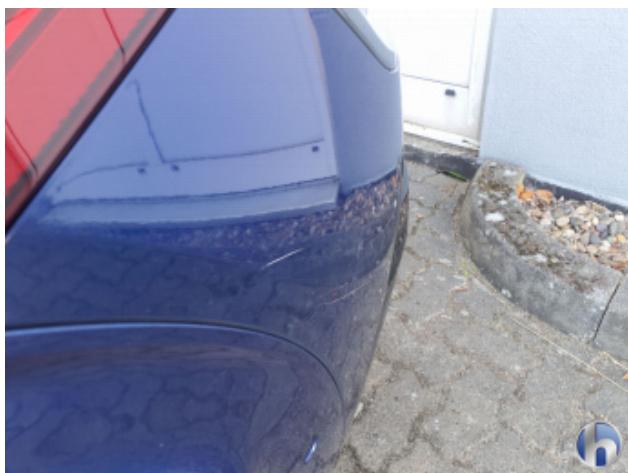
3. Seitenwand - Hinten - Links Kratzer - Smart Repair
