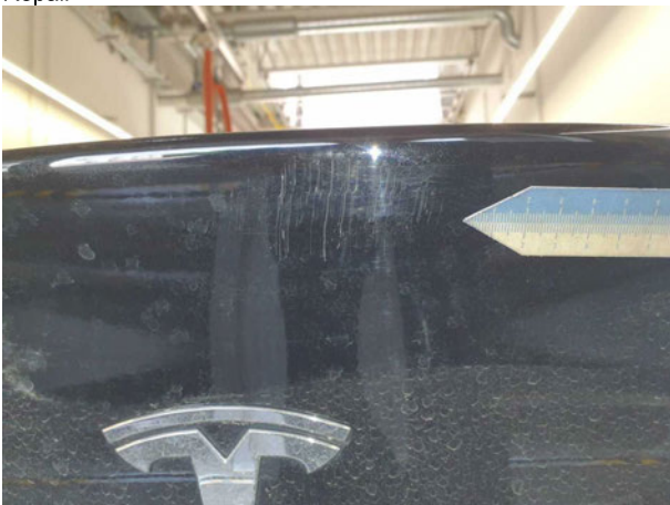
Beschädigung #3: Heckklappe/-tür: Heckklappe - Kratzer - Smart Repair
