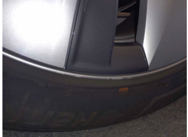
Beschädigung #1: Rad/Reifen: Leichtmetallfelge vorn links - Kratzer - Wertminderung
