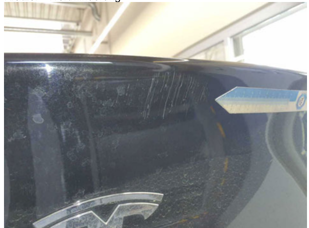
Beschädigung #3: Heckklappe/-tür: Heckklappe - Kratzer - Smart Repair
