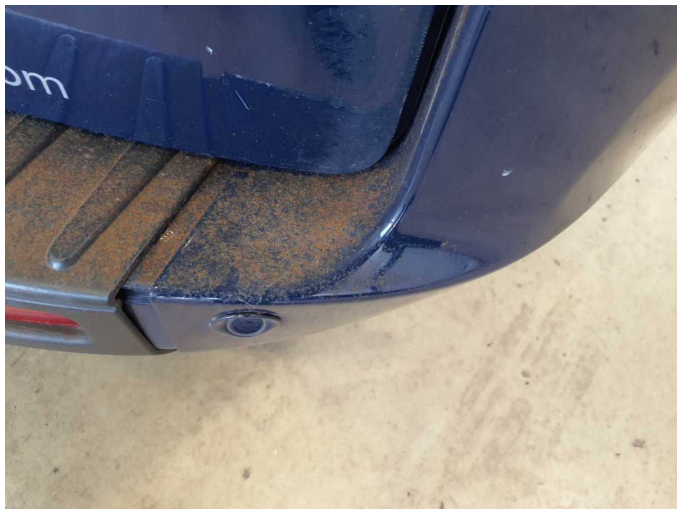
Damage 6: Rear bumper: Rear bumper (Verschmutz durch Metalabrieb) - Soiled - Clean
