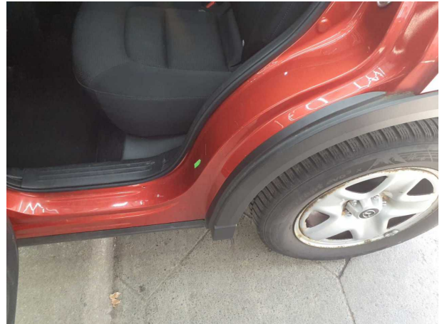
Beschädigung #4: Seitenwand links: Einstieg - Kratzer - lackieren
