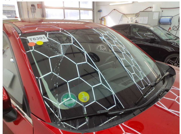
Beschädigung #8: Verglasung: Frontscheibe - gebrochen / gerissen - erneuern
