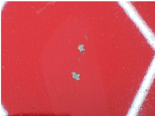
Beschädigung #7: Motorhaube: Motorhaube - Steinschlag - lackieren
