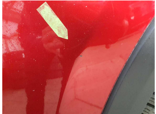
Beschädigung #6: Stossfänger vorn: Stossfänger vorn - verkratzt / verschürft - lackieren
