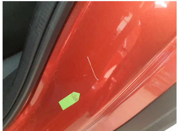
Beschädigung #4: Seitenwand links: Einstieg - Kratzer - lackieren
