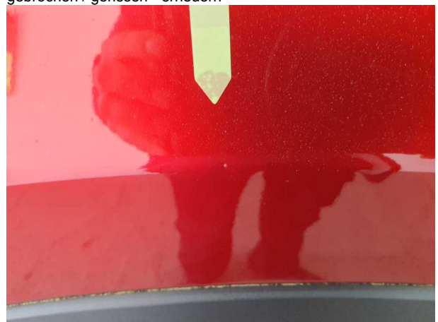
Beschädigung #3: Seitenwand rechts: Seitenwand - Delle / Lackschaden - Smart Repair
