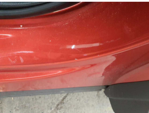
Beschädigung #4: Seitenwand links: Einstieg - Kratzer - lackieren
