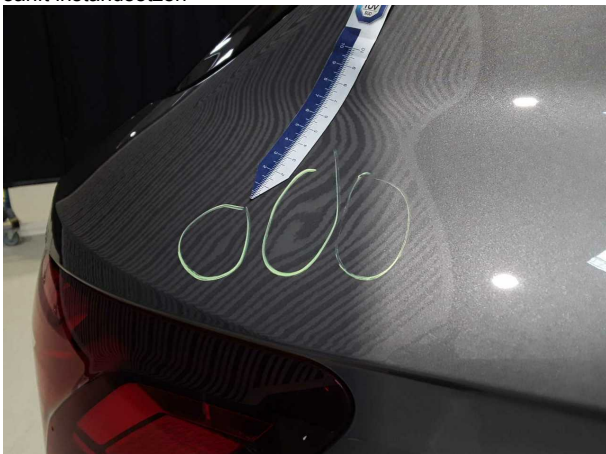
Beschädigung #1: Seitenwand rechts: Seitenwand - Delle(n) - sanft instandsetzen
