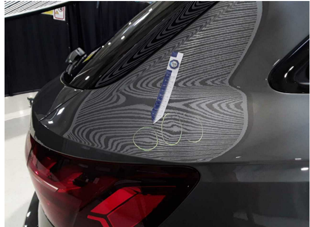
Beschädigung #1: Seitenwand rechts: Seitenwand - Delle(n) - sanft instandsetzen
