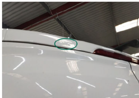
Dachholm / Hinten / Delle
