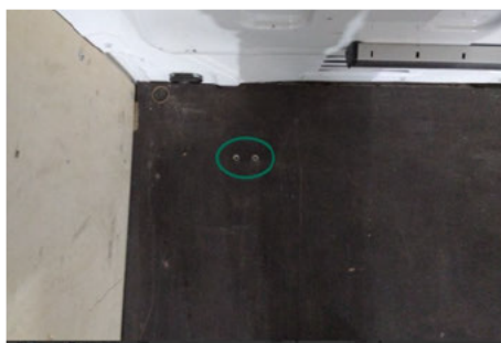
Holzboden / Hinten / Nicht konform
