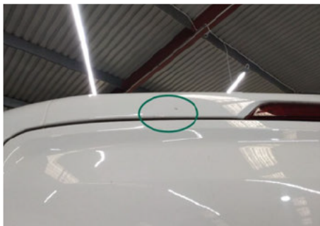
Dachholm / Hinten / Delle
