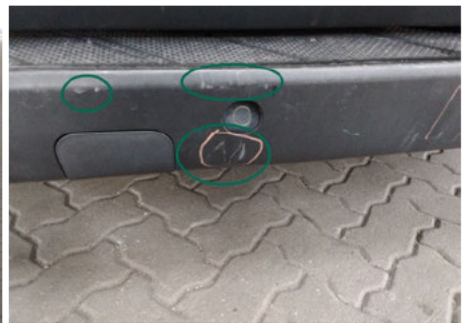
Stoßfänger / Hinten / Kratzer
