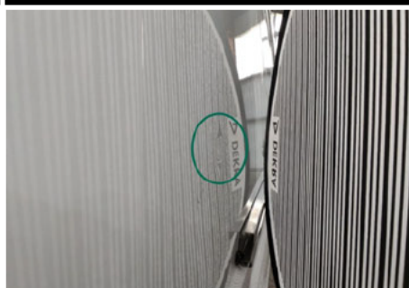
Seitenwand / Mitte Hinten Rechts / Delle
