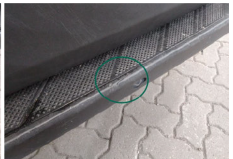
Stoßfänger / Hinten / Kratzer
