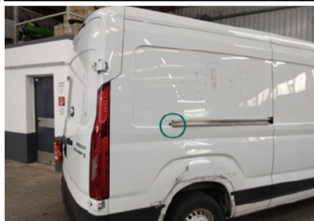
Abdeckung / Hinten Rechts / Fehlt
