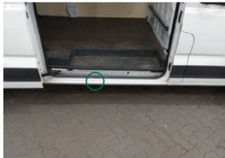
Türeinstieg / Rechts / Delle
