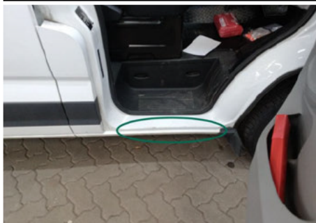
Türeinstieg / Vorne Rechts / Abgewetzt
