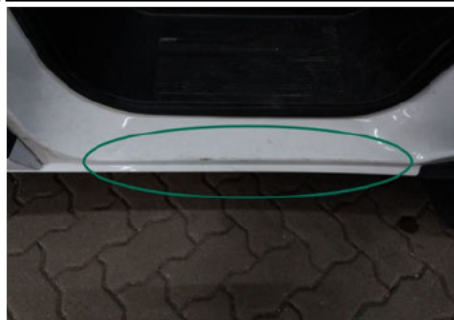
Türeinstieg / Vorne Rechts / Abgewetzt
