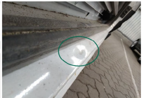
Türeinstieg / Rechts / Delle
