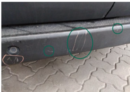
Stoßfänger / Hinten / Kratzer
