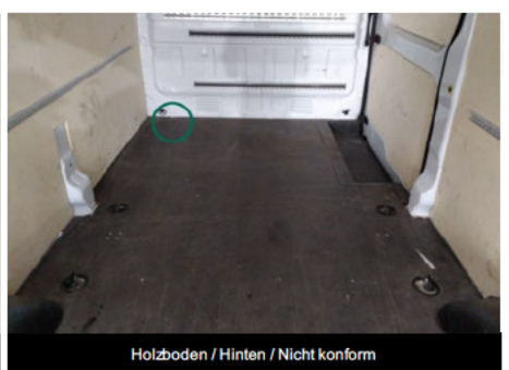
Holzboden / Hinten / Nicht konform
