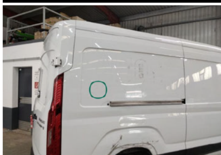
Seitenwand / Mitte Hinten Rechts / Delle
