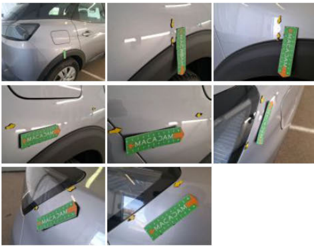
Porte ARD, Bosse(s), LI - Réparer et peindre (complet)
