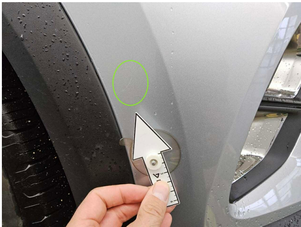
Bild 13 : Stoßfänger vorne Lackierung, zerkratzt, Gebrauchsspur
