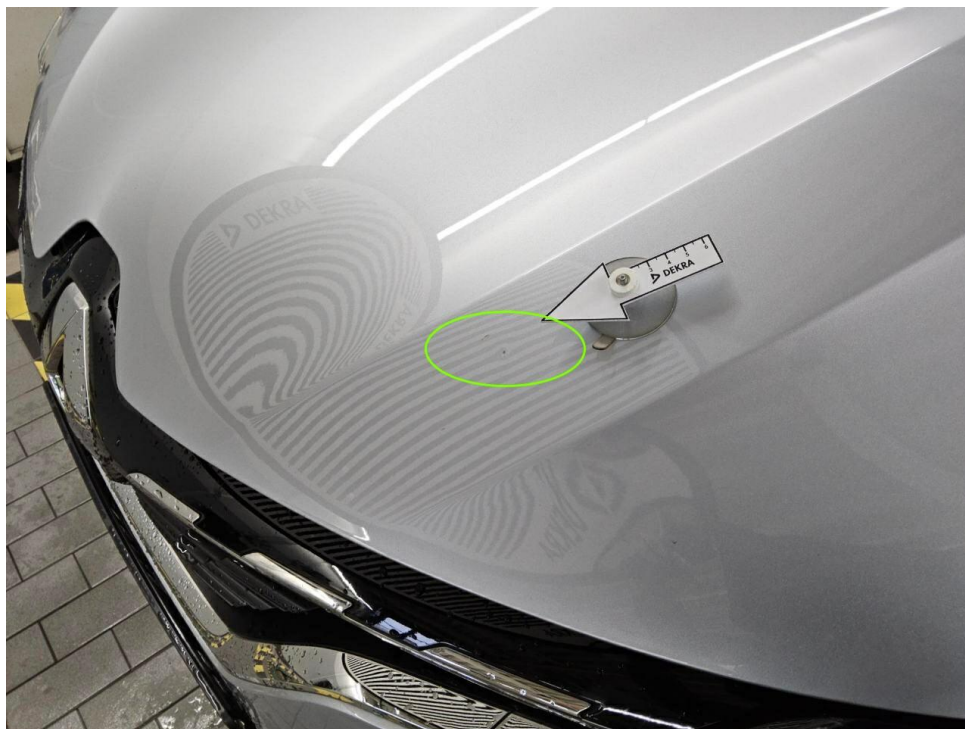
Bild 17 : Motorhaube Lackierung, Steinschlag, Gebrauchsspur
