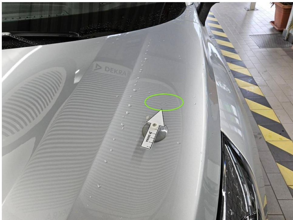
Bild 18 : Motorhaube, mehrfach eingedellt, Gebrauchsspur
