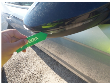
Side turning sign signal / Izquierda / Roto
