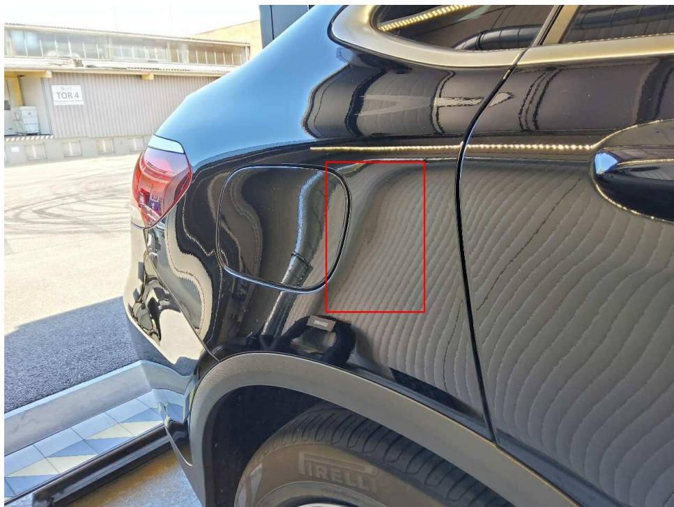
Bild 20 : Seitenwand hinten rechts, eingedellt
