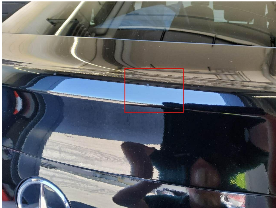
Bild 22 : Heckklappe oberhalb, eingedellt und verschrammt
