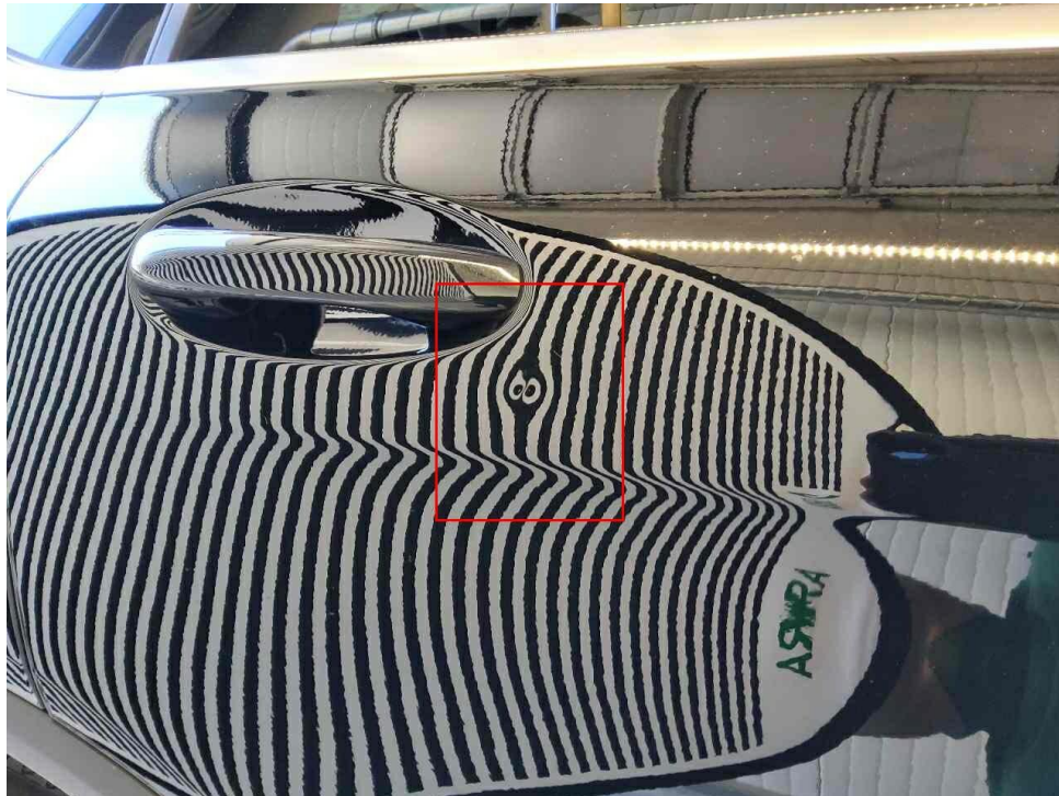
Bild 19 : Tür hinten rechts, eingedellt und verschrammt
