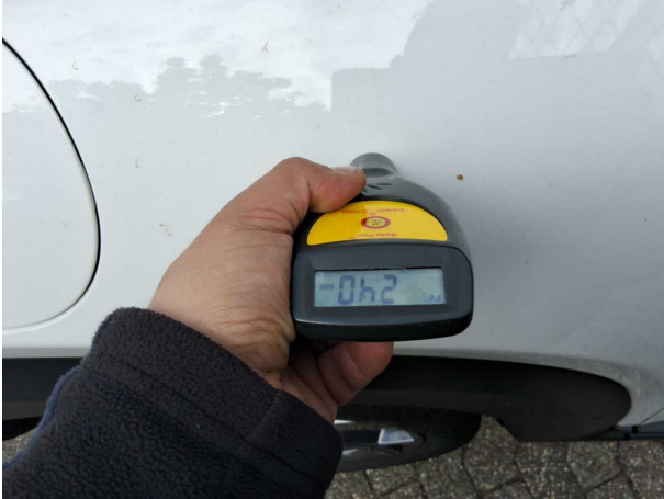
Nachlackierung 1: Seitenwand rechts
