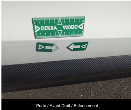
Porte / Avant Droit / Enfoncement
