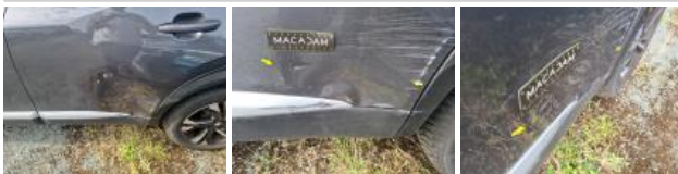
Door FL, Scratch(es), Paint
