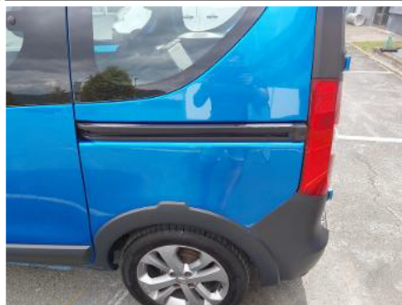
Führung Schiebetür / Links / Abgewetzt
