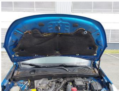
Dämmung Motorhaube / - / Verschlissen
