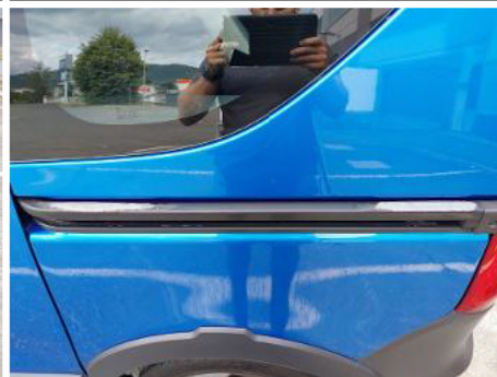
Führung Schiebetür / Links / Abgewetzt
