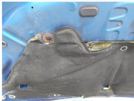
Dämmung Motorhaube / - / Verschlissen
