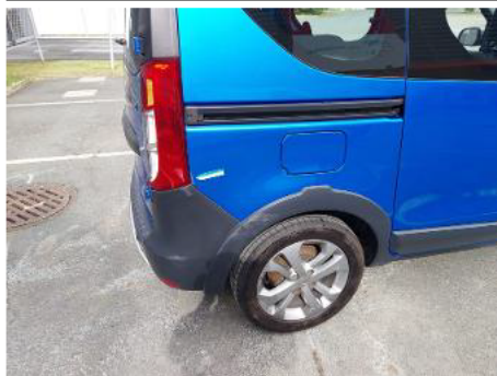
Kotflügel / Hinten Rechts / Kratzer
