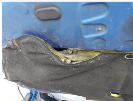
Dämmung Motorhaube / - / Verschlissen
