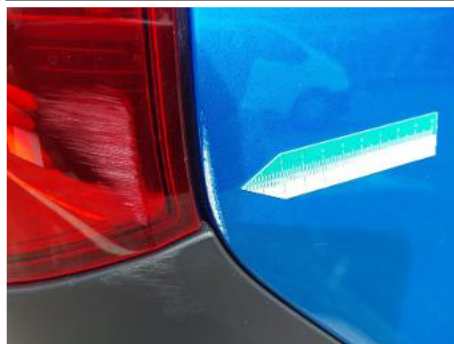
Kotflügel / Hinten Rechts / Kratzer
