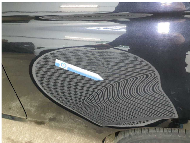
Beschädigung #3: Seitenwand links: Seitenwand - Delle(n) - sanft instandsetzen
