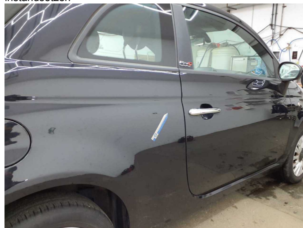
Beschädigung #4: Seitenwand rechts: Seitenwand - Delle(n) - sanft instandsetzen
