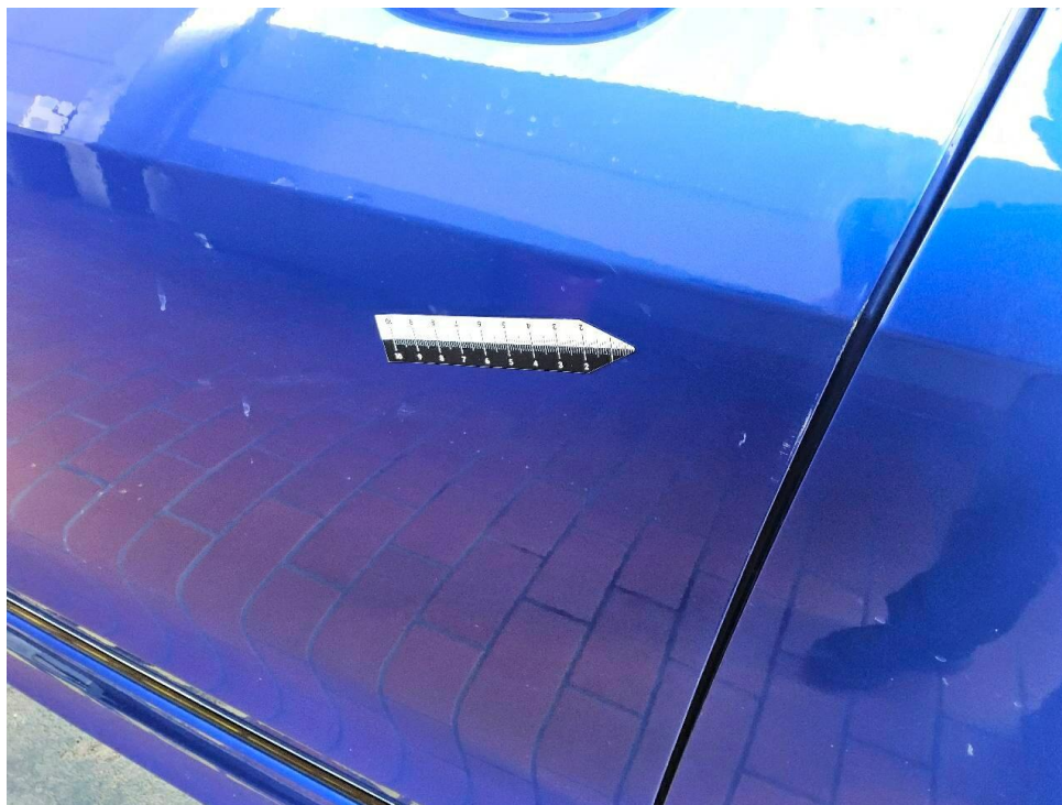
Bild 14 : Tür vorne links zerkratzt
