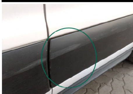
Türzdeerleiste / Vorne Rechts / Kratzer
