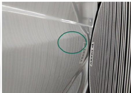
Tür / Rechts / Delle
