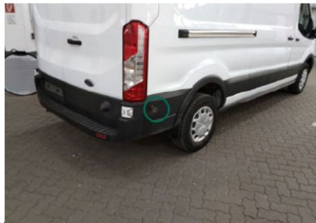
Türanschlag/-puffer / Hinten Rechts / Fehlt
