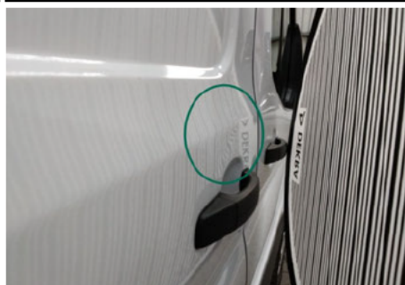
Tür / Rechts / Delle
