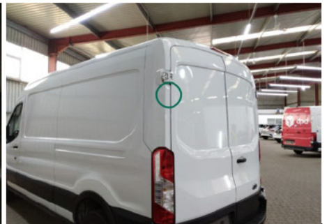
Säule / Oben Hinten Links / Schlecht Repariert
