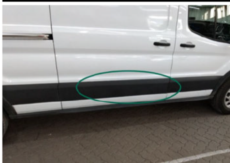
Türzdeerleiste / Rechts / Kratzer
