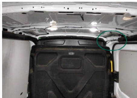
Abdeckung / Innenraum Vorne Rechts / Fehlt
