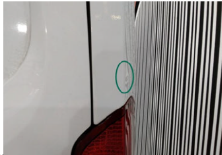
Säule / Oben Rechts / Delle
