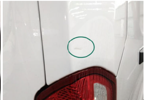
Säule / Oben Rechts / Delle
