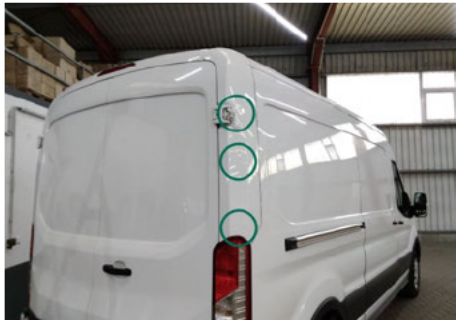
Säule / Oben Rechts / Delle
