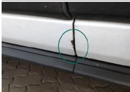
Tür / Rechts / Delle
