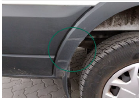
Kotflügelzdeerleiste / Hinten Rechts / Kratzer
