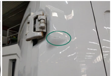
Säule / Oben Rechts / Delle
