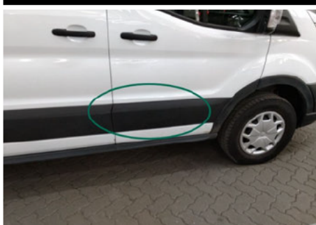
Türzdeerleiste / Vorne Rechts / Kratzer
