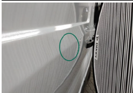
Tür / Rechts / Delle
