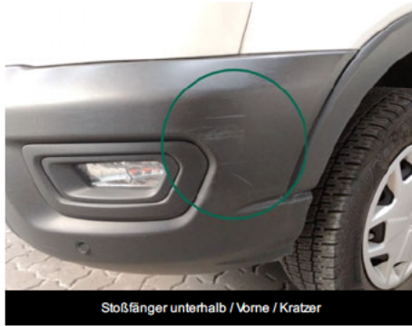
Stoßfänger unterhalb / Vorne / Kratzer
