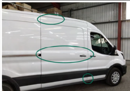
Tür / Rechts / Delle
