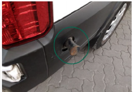
Türanschlag/-puffer / Hinten Rechts / Fehlt
