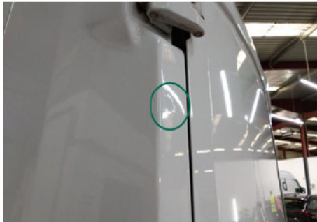
Säule / Oben Hinten Links / Schlecht Repariert
