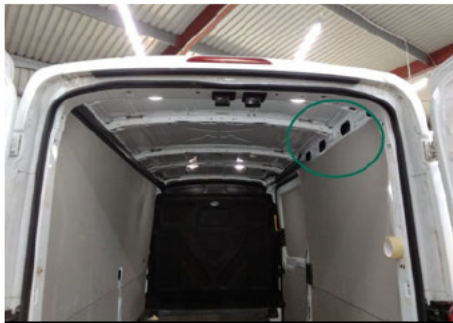
Abdeckung / Innenraum Hinten Rechts / Fehlt
