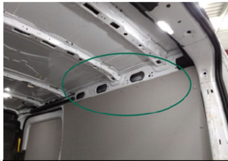
Abdeckung / Innenraum Hinten Rechts / Fehlt
