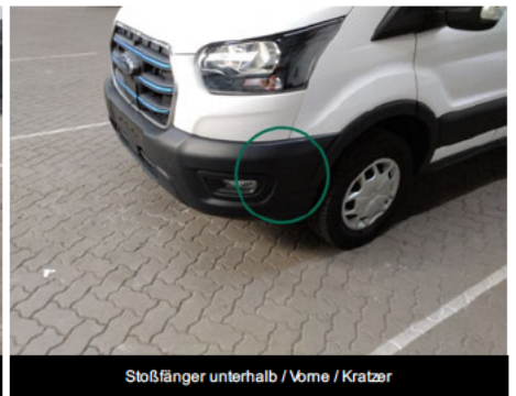
Stoßfänger unterhalb / Vorne / Kratzer
