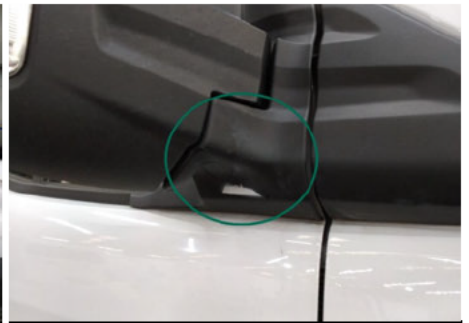
Außenspiegelhalter Abdeckung / Vorne Rechts / Fleck
