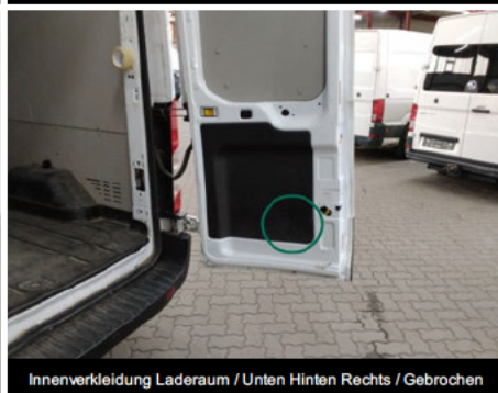
Innenverkleidung Laderaum / Unten Hinten Rechts / Gebrochen
