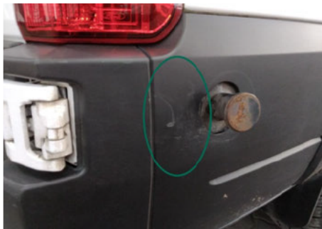
Stoßfänger / Hinten Rechts / Kratzer
