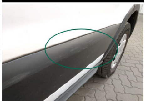
Türzdeerleiste / Vorne Rechts / Kratzer
