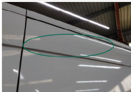
Tür / Rechts / Delle
