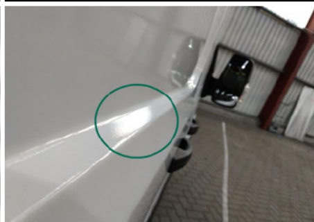
Tür / Rechts / Delle
