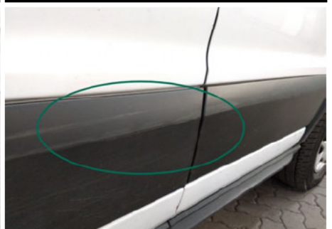
Türzdeerleiste / Rechts / Kratzer
