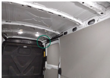
Abdeckung / Innenraum Vorne Rechts / Fehlt
