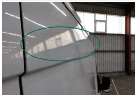
Tür / Rechts / Delle
