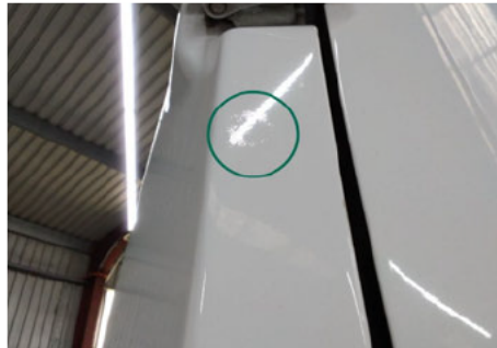
Säule / Oben Hinten Links / Schlecht Repariert
