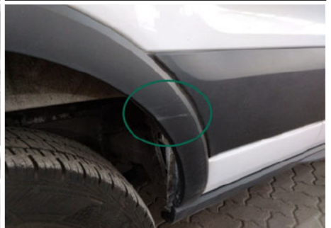
Kotflügelzdeerleiste / Hinten Rechts / Kratzer
