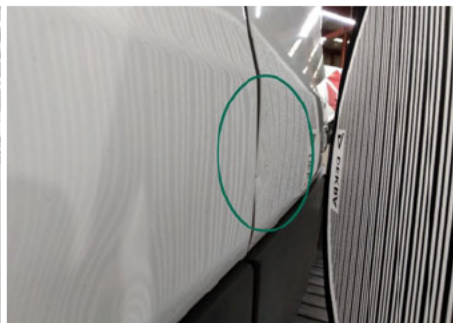
Heckklappe / Kofferraumtür / Unten Rechts / Delle
