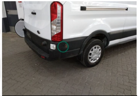
Stoßfänger / Hinten Rechts / Kratzer
