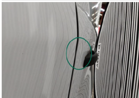
Heckklappe / Kofferraumtür / Unten Rechts / Delle
