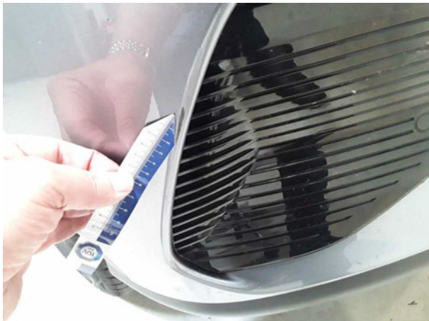
Beschädigung #2: Stossfänger vorn: Stossfänger vorn - verkratzt / verschürft - instandsetzen und lackieren
